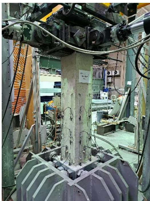
Figura 3.8- Montagem e monitorização do provete DBC no LESE.
