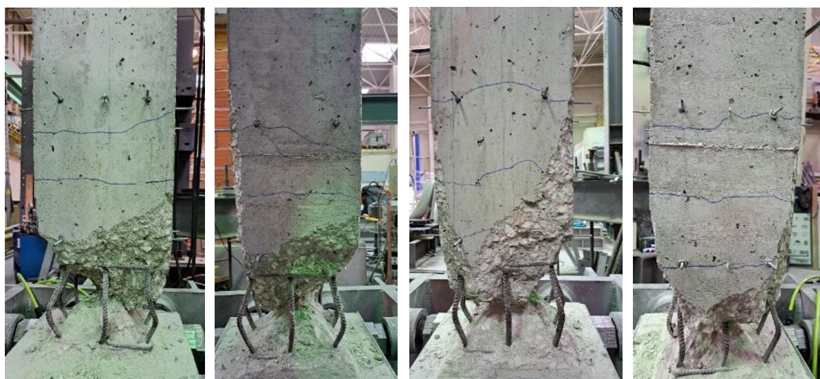
a) b) c) d) Figura 4.27-Provete DBC no final do ensaio na: a) face N; b) face E; c) face S; d) face O.
