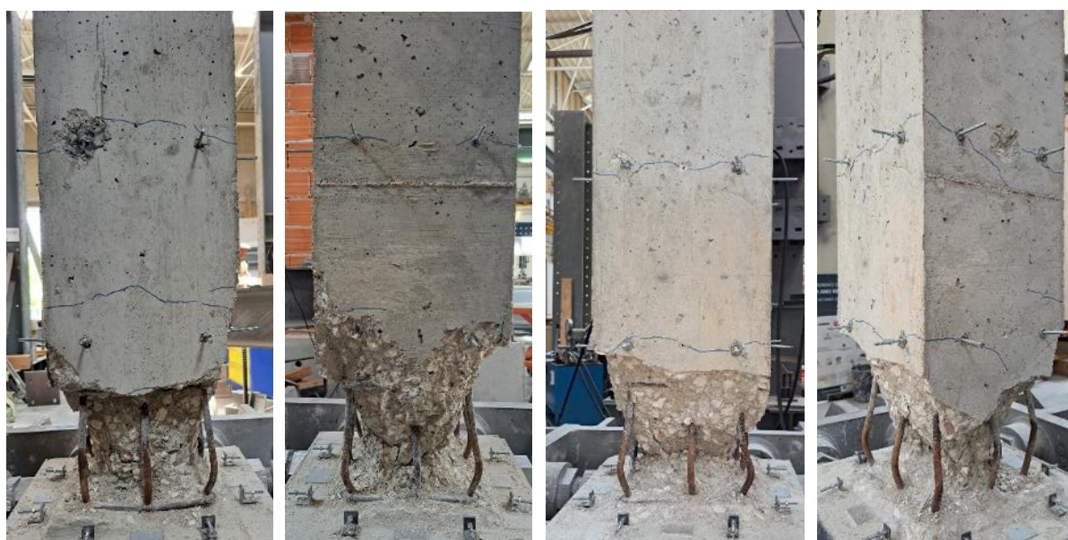
a) b) c) d) Figura 4.28-Provete PBE no final do ensaio na: a) face N; b) face E; c) face S; d) face O.
