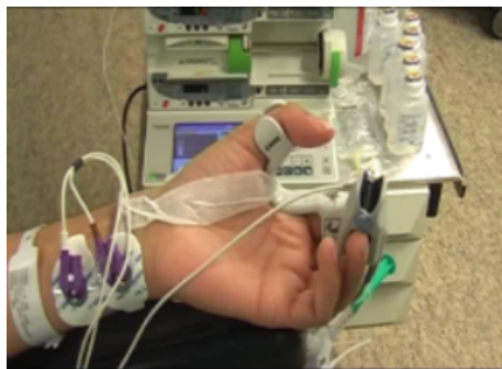
FIGURA 1.2: Sensor de bloqueio neuromuscular (NMB): Esta fotografia ilustra o equipamento de monitorização do NMB, Datex-Ohmeda, com elétrodos de estimulação aplicados sobre o nervo ulnar e o sensor de NMB aplicado para medir os movimentos do polegar (sensor de força que mede a contração do polegar induzida pela estimulação elétrica).
