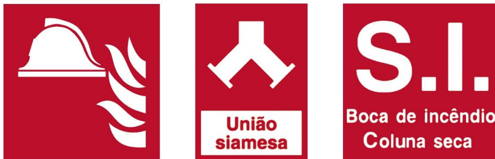
Fig. 8 - Sinalização de alguns meios de 2ª intervenção [20, 21].
