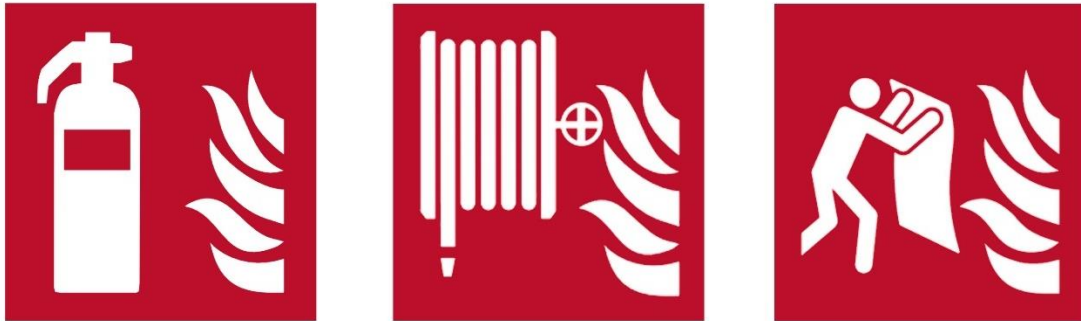
Fig. 7 - Sinalização de alguns meios de 1ª intervenção [20].
