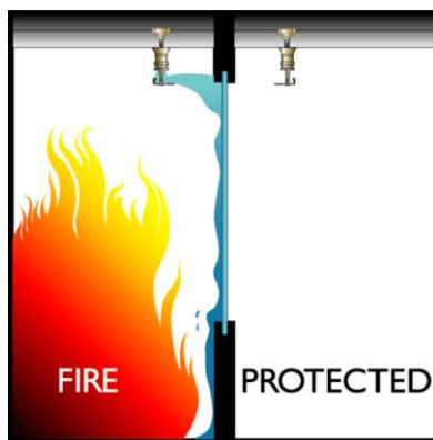
Fig. 22 - Esquema de funcionamento dos sistemas de cortina de água [41].
