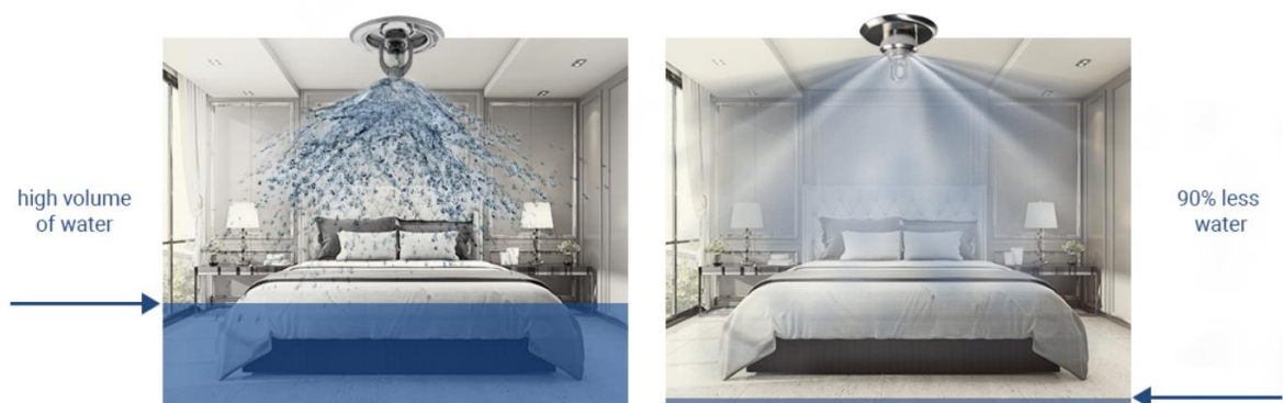
Fig. 24 - Comparação do volume de água utilizado: sprinkler tradicional vs de água nebulizada [42].
