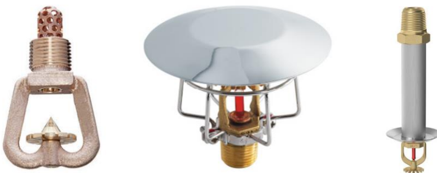
Fig. 16 - Sprinkler aberto (esq.), para nível intermédio (centro) e seco (dir.) [31-33].
