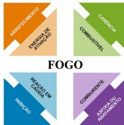
Fig. 6 - mecanismos de extinção. Adaptado de [14].
