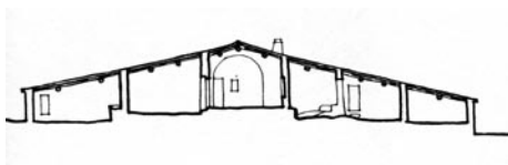
Fig.190 – Monte da Abaneja, arredores de Évora -«[...] de modestas dimensões, é um exemplo puro deste tipo de construções, duma beleza calma, de amplo telhado de baixa inclinação. Claro sob o ponto de vista da sua distribuição e do seu aspecto construtivo. [...] a sua secção revela-nos a 'naturalidade' com que surge da terra tal construção, o telheiro acompanha o declive do terreno, a construção não o contraria, agarra-se, adapta-se, tal como a lagarta acompanha os acidentes da terra por onde passa.»
