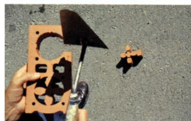
Fig.77 - Tijolo Ladriflor - específico para alvenaria armada
