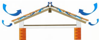
Fig.186 – Mecanismo de ventilação entre beirado e cumeeira
