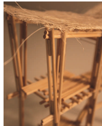
Fig.48. Estudo do sistema construtivo em bambu.
