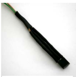
75. Sensor de Temperatura LM35
