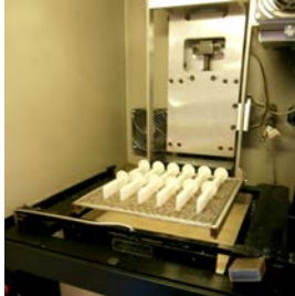
90. Processo de Esteriolitografia Peças já fora da cuba com resina
