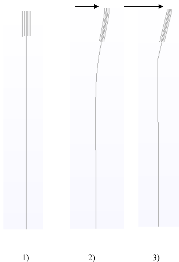
Figura 57 - Evolução da deformada da estaca: 1) Estaca estática, 2) Carga intermédia aplicada, 3) Carga Última aplicada (Rotura)
