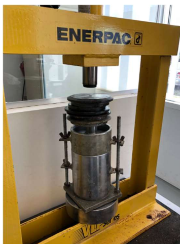
Fig. 41 – Molde usado para o ensaio UCS
