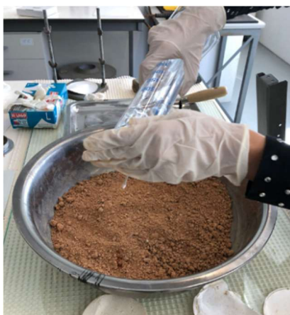
Fig. 40 – Adição do teor ótimo de água ao solo
