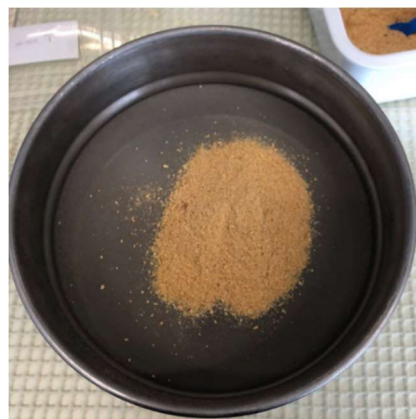
Fig. 24 – Peneiração das partículas na malha 250mm
