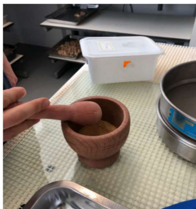
Fig. 23 – Moagem das partículas de soja com recurso a um pilão
