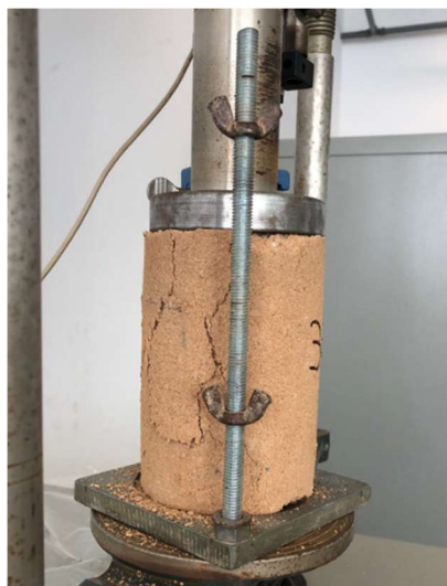
Fig. 43 – Provete fissurado após ensaio UCS
