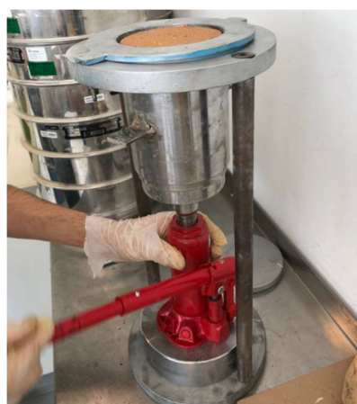
Fig. 38 - Mecanismo de desmolde dos provetes com recurso a macaco hidráulico
