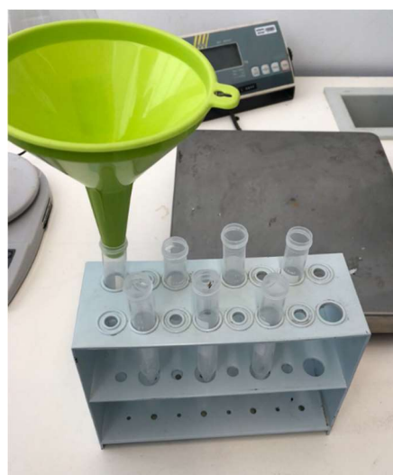
Fig. 28 – Adição de água destilada aos tubos de ensaio
