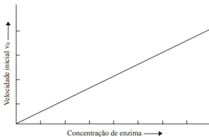
Fig. 18 – Efeito da concentração de enzima sobre a velocidade inicial da reação [34]
