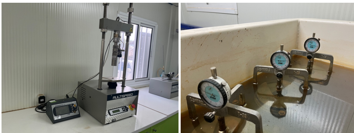
Figura 15 - Ensaio CBR, equipamento e ensaio e expansão
