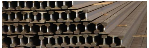
-94- Os carris ferroviários tomaram-se nos elementos percussores do perfil metálico utilizado na construção.
