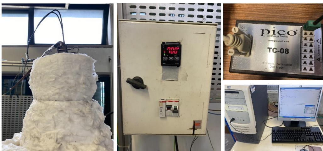
Figura 5.7 - Sistema de controlo e medição da temperatura no interior do queimador.
