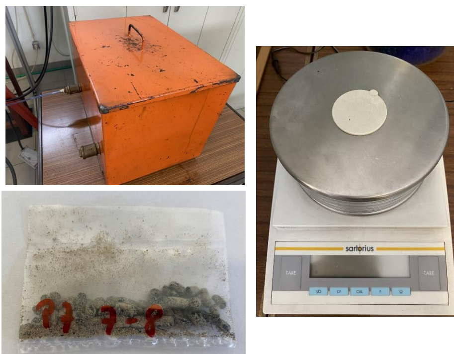
Figura 5.12 - Câmara de arrefecimento, balança utilizada nas pesagens e embalagem de uma carga coletada.
