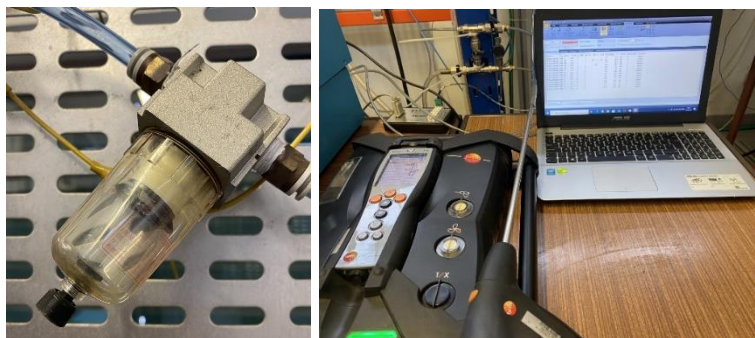
Figura 5.10 - Sistema de filtragem dos gases de combustão e analisador.
