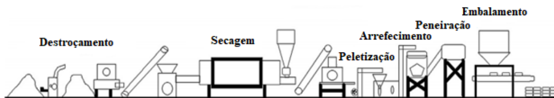
Figura 2.16 - Esquema do processo de produção de péletes. Adaptado de: Obernberger & Thek (2010).
