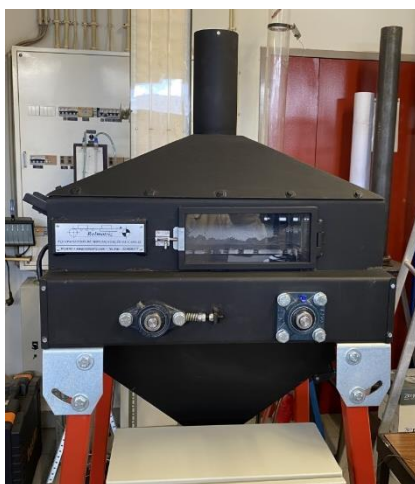
Figura 5.3 - Queimador em leito móvel.
