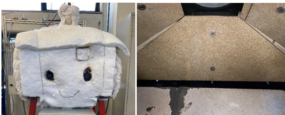
Figura 5.6 - Isolamento, externo e interno, do queimador.
