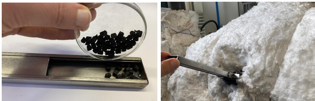
Figura 5.11 - Procedimento de ensaio: colocação da carga no alimentar e sua inserção no queimador.
