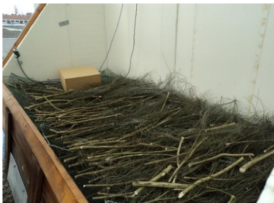
Figura 4.2 - Secagem da espécie Cytisus scoparius em estufa solar.
