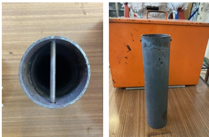
Figura 4.8 - Copo cilíndrico utilizado na carbonização.
