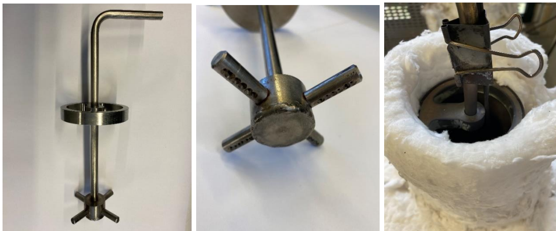
Figura 5.9 - Coletor de aspiração dos gases de combustão.
