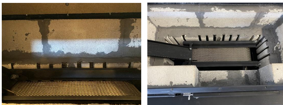
Figura 5.5 - Grelha transportadora (vista frontal e vista superior).
