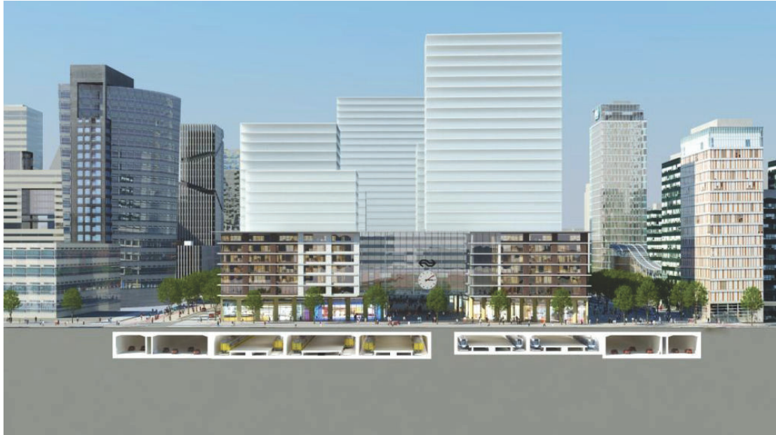
44. Dockmodel, primeiro plano dos túneis infra-estruturais
