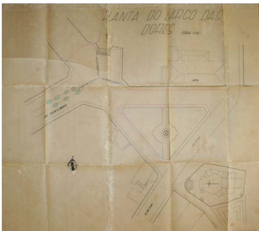
Fig. 49- Planta com o projecto para Pavimentação a Paralelepípedos da faixa de rodagem e construção de passeios do Largo das Dores entre a Avenida Mousinho de Albuquerque, Rua das Dores e E.N. 205 - 1947
