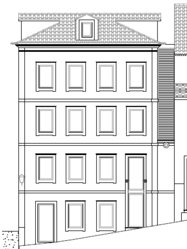
Figura 70 – Alçado Sul com grelha metálica no espaço entre os edifícios.
