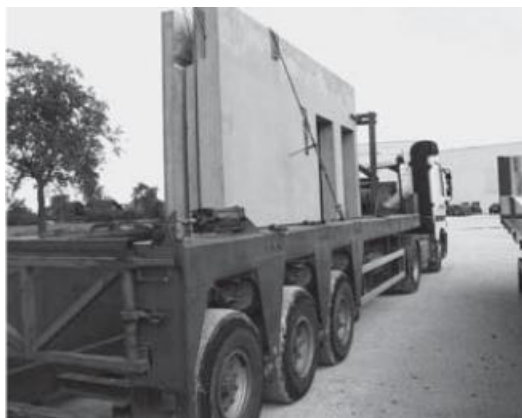
Fig. 3.34 – Semi-reboque, transporte do painel de fachada [28]
