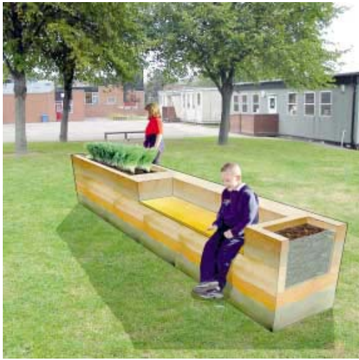
Fig. 124 – Espaço de convívio e descanso (em cima) e banco produzido em terra compactada (em baixo). Escola primária Ballifield, Sheffield, Inglaterra.
