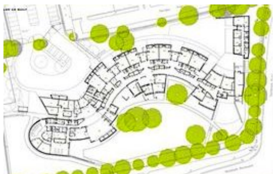
Fig. 92 – Esquema de territórios diversificados no estabelecimento dos vazios intersticiais provocados pelas torções da estrutura distributiva (em cima); planta do rés-do-chão (em baixo). Escola Hazelwood, Glasgow, Escócia (Gordon Murray, Alain Dunlop, 2007).
