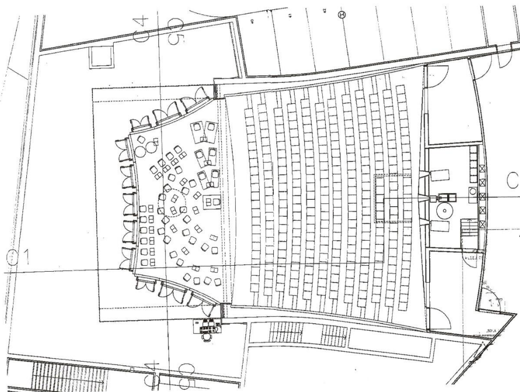
Figura 102. Planta do auditório com concha acústica.
