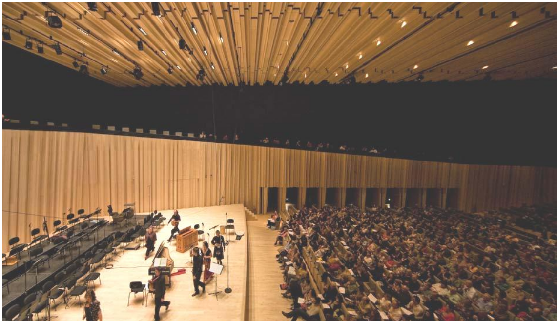
Figura 40. Dimensionamento acústico de uma sala: Shoe-box ou caixa de sapatos.
