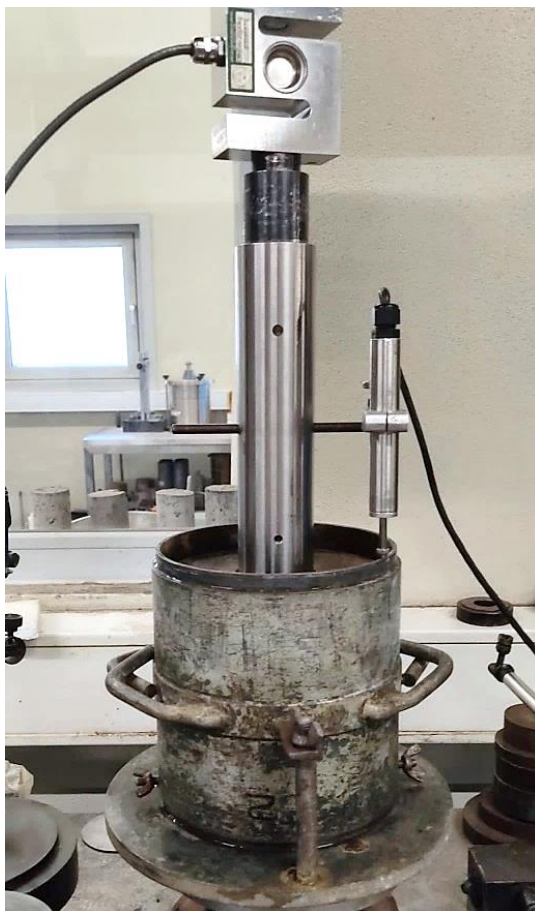
Figura 21 – Pistão ao penetrar a amostra
