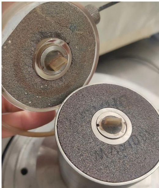
Figura 30 – Bender elements no topo e na base da câmara triaxial
