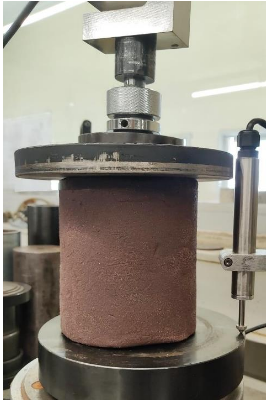
Figura 26 – Configuração do ensaio de compressão simples
