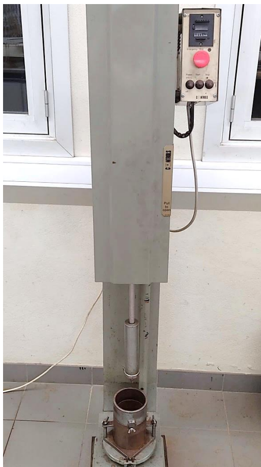
Figura 16 – Compactador automático utilizado na compactação dinâmica
