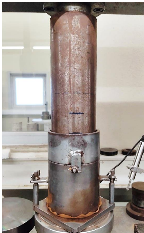
Figura 17 – Compactação estática utilizando molde Proctor
