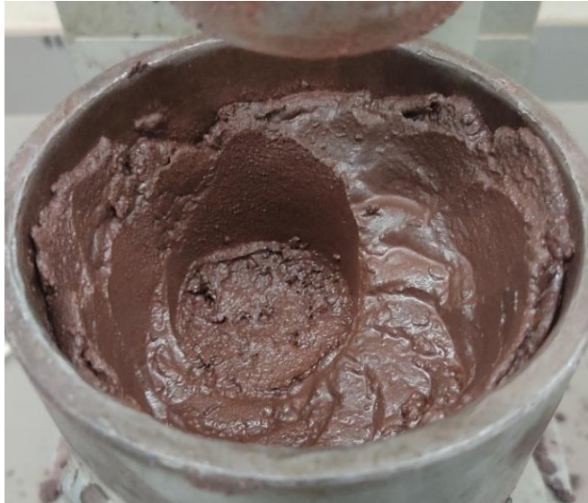
Figura 34 – Migração de água para o topo da amostra durante compactação dinâmica
