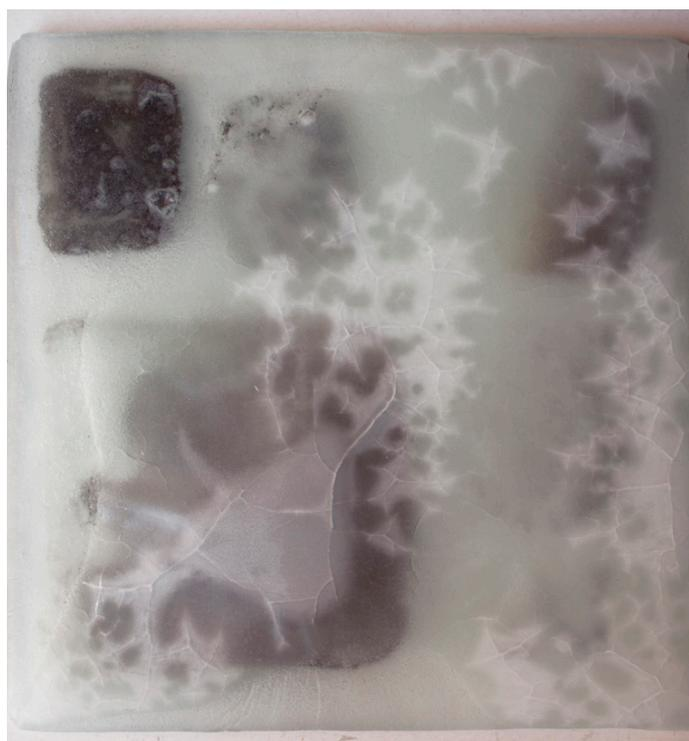
Vidro pintado fosco a areia (4 mm) + vidro superior transparente float (4 mm). Fusão total 820°, com 1h30 de patamar (forno A).
