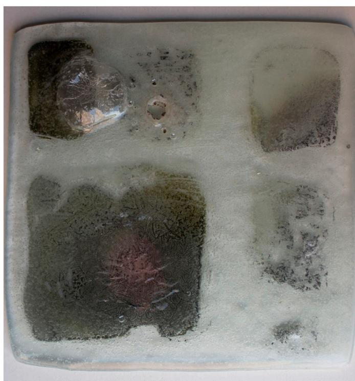
Vidro pintado fosco a ácido (4 mm) + vidro superior transparente float (4 mm). Fusão total 820°, com 10 min de patamar (forno A).
