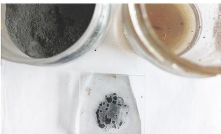
Fig. 1 Exemplo de sobreposição de dois retalhos de vidro para fusão e pintura com pigmento de ardósia e goma arábica.
