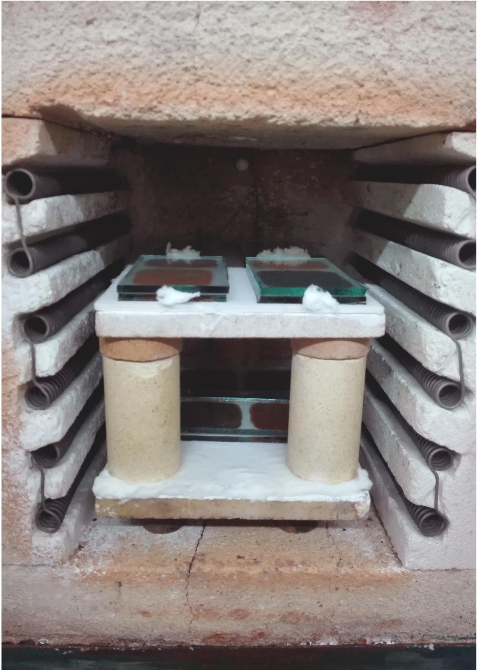
Vidro pintado transparente float (4 mm) + vidro superior transparente float (4 mm). Fusão total 800° (forno 2).
