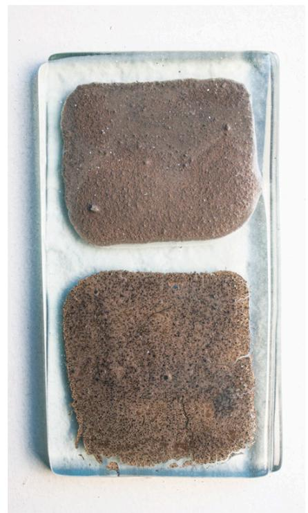
Vidro pintado transparente float (4 mm) + vidro superior transparente float (4 mm). Fusão total 800° (forno 9).
