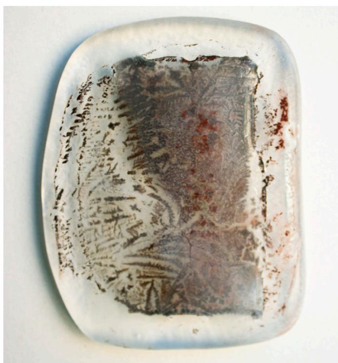
Vidro pintado transparente float (4 mm) + vidro superior parcialmente pintado transparente float (4 mm). Fusão total 800° (forno pequeno manual).
