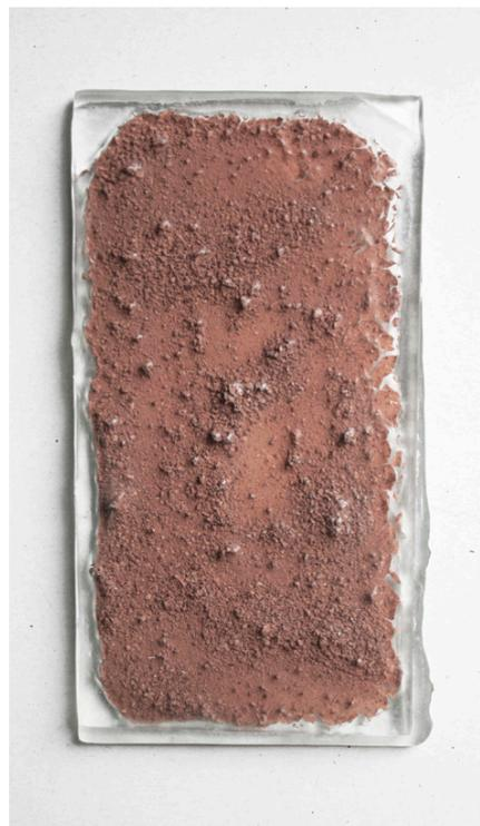
Vidro pintado transparente float (2 mm) + vidro superior transparente float (2 mm). Fusão total 800° (forno 2).
