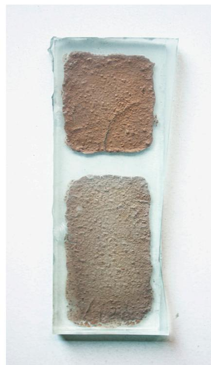
Vidro pintado fosco em ácido (3 mm) + vidro superior transparente float (5 mm). Fusão parcial 700° (forno 9).
