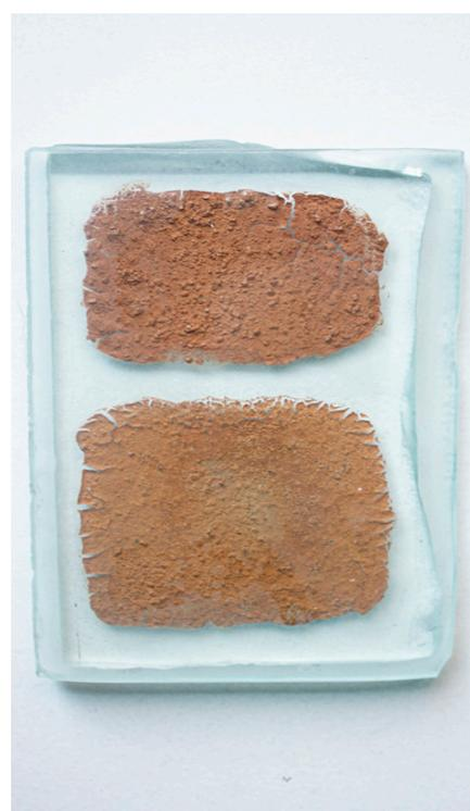
Vidro pintado fosco em ácido (2 mm) + vidro superior transparente float (0,6 mm). Fusão parcial 700° (forno 9).
