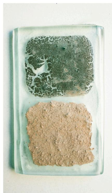
Vidro pintado transparente float (2 mm) + vidro superior transparente float (2 mm). Fusão total 800° (forno 9).
