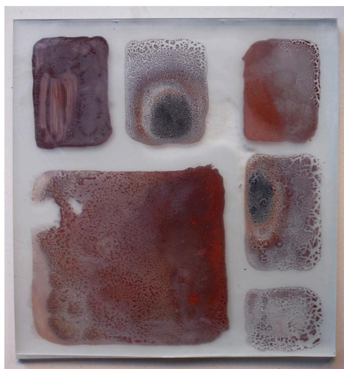
Vidro pintado transparente float (4 mm) + vidro superior transparente float (4 mm). Fusão parcial 700° (forno A).
