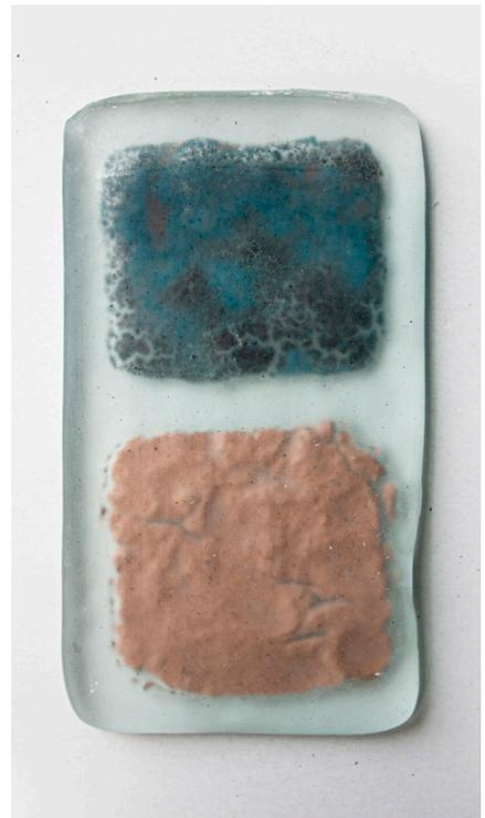
Vidro pintado transparente float (2 mm) + vidro superior transparente float (2 mm). Fusão parcial 715° (forno A).
