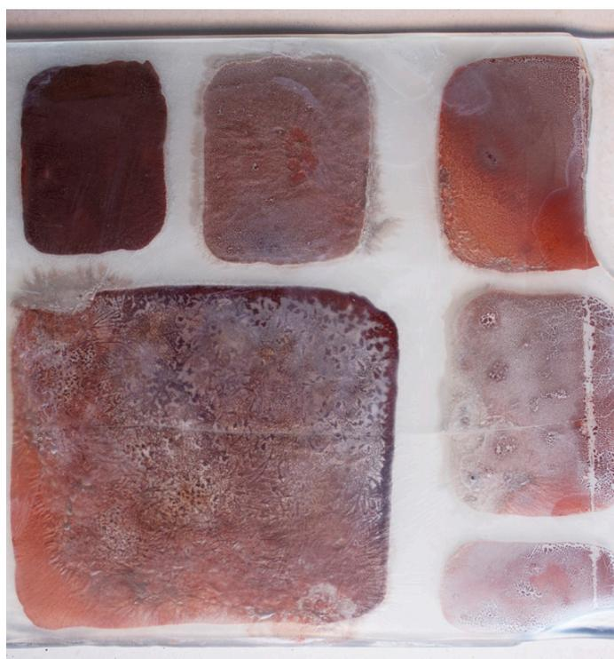
Vidro pintado transparente float (4 mm) + vidro superior transparente float (4 mm). Fusão total 820°, com 1h30 de patamar (forno A).
