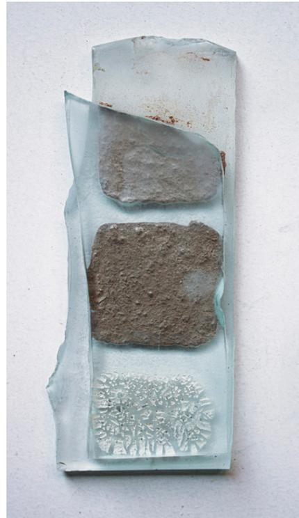
Vidro pintado fosco em ácido (4 mm) + vidro superior transparente float (4 mm). Fusão parcial 700° (forno 9).
