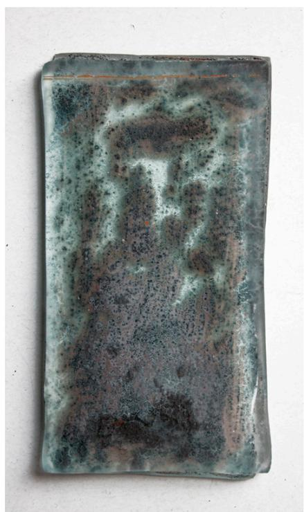
Vidro pintado transparente float (2 mm) + vidro superior transparente float (2 mm). Fusão total 800° (forno 2).
