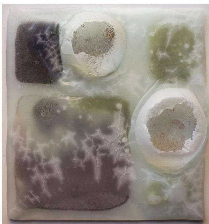
Vidro pintado fosco a ácido (4 mm) + vidro superior transparente float (4 mm). Fusão total 820°, com 1h30 de patamar (forno A).
