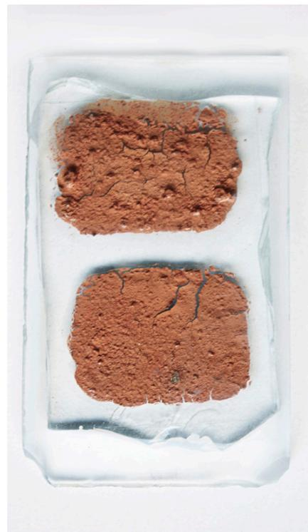
Vidro pintado fosco em ácido (5 mm) + vidro superior transparente float (5 mm). Fusão parcial 700° (forno 9).
