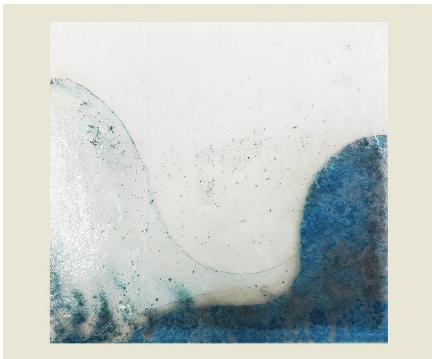
Vidro pintado transparente float (3 mm) + vidro superior float (3 mm). Fusão total 780° (forno c).
