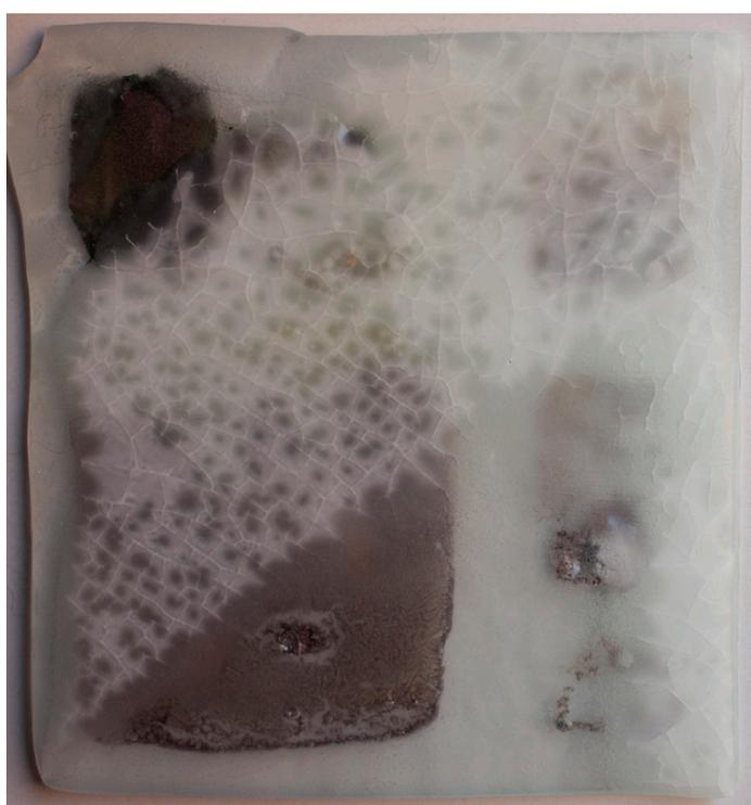
Vidro pintado fosco a areia (4 mm) + vidro superior transparente float (4 mm). Fusão total 820°, com 10 min de patamar (forno A).
