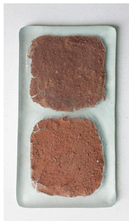
Vidro pintado transparente float (2 mm) + vidro superior transparente float (2 mm). Fusão parcial 700° (forno 2).
