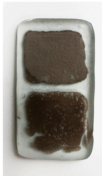
Vidro pintado transparente optical clear (18 mm) + vidro superior transparente optical clear (18 mm). Fusão total 800° (forno 9).
