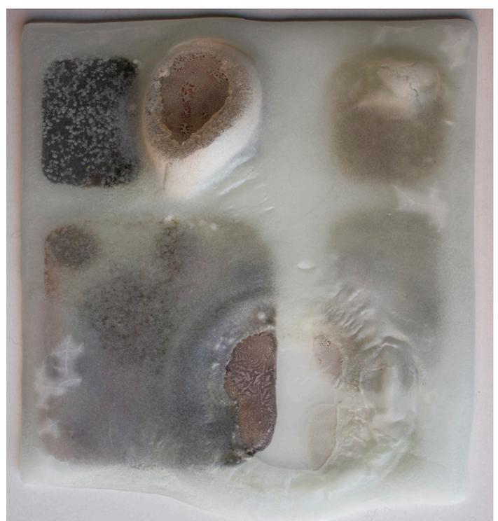
Vidro pintado transparente float (4 mm) + vidro superior transparente float (4 mm). Fusão total 820°, com 10 min de patamar (forno A).
