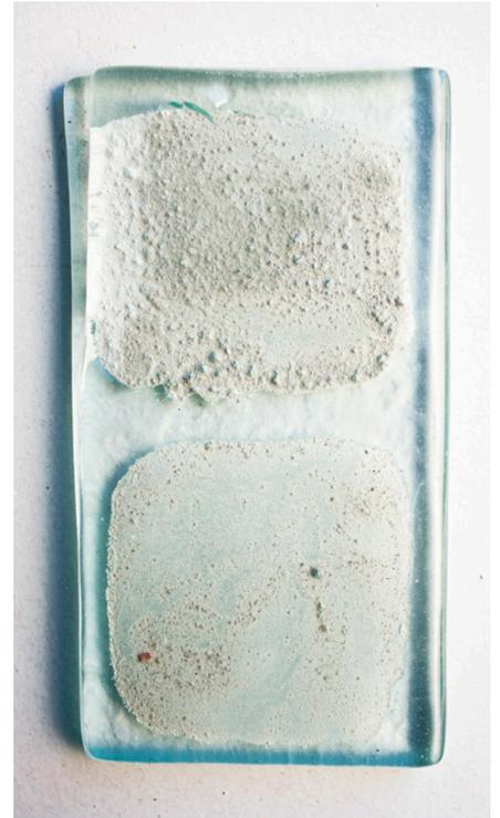
Vidro pintado transparente float (2 mm) + vidro superior transparente float (2 mm). Fusão total 800° (forno 9).
