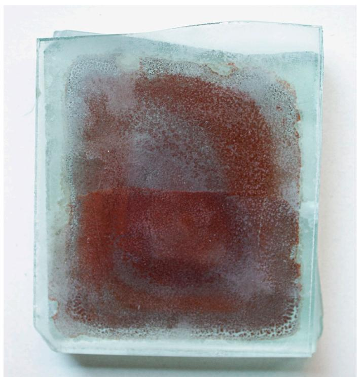
Vidro pintado transparente optical clear (18 mm) + vidro superior parcialmente pintado transparente optical clear (18 mm). Fusão total 800° (forno 9).
