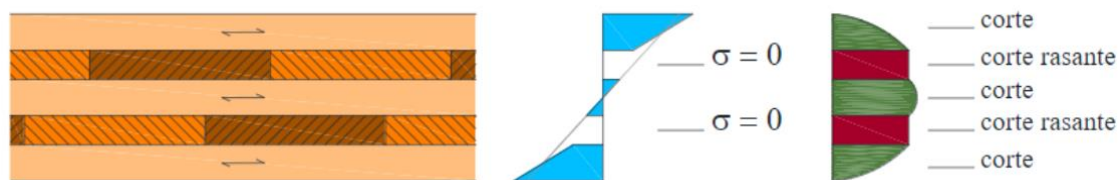
Figura 4. 3. – Tensões CLT, (Lourenço et al. 2013)
