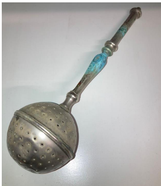
Figura ApD25 – Corrosão de um hissope. © Diana Ribeiro, 2022.
