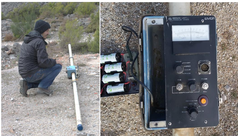
Figura 4.7. Dispositivo fabricado pela Geonics Lmt, série EM31
