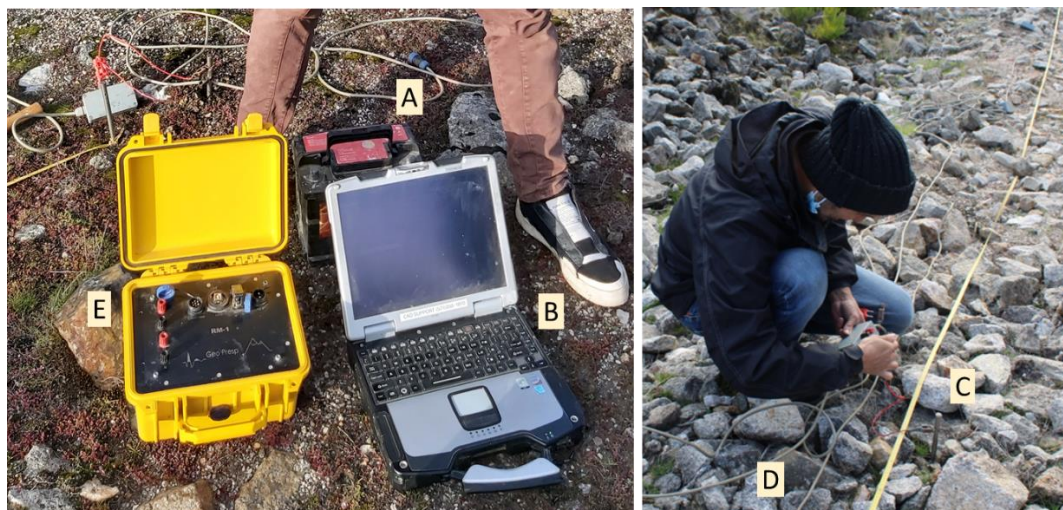
Figura 3.10. Equipamento utilizado para a geração dos perfis resistivos (ERT).
