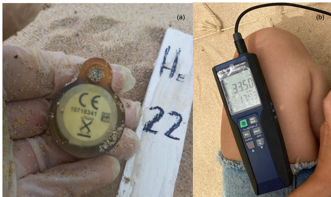
Figura 20 – À esquerda (a) Data logger (Tidbit®) usado durante a experiência (foto: Sara Teles) e à direita (b) termómetro digital com sonda (PCE –HPT1 RTD) (Foto: Diana Guedes). João Barrosa, Ilha da Boa Vista, Cabo Verde.
