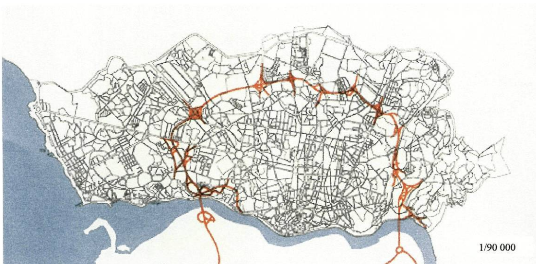
Figura 30 – Traçado da Via de Cintura Interna
