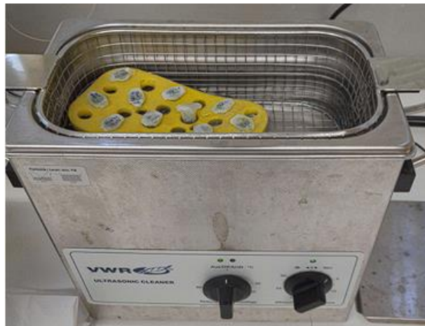
Figura 5 - Amostras durante o banho de limpeza ultrassónica (VWR USC300TH).
