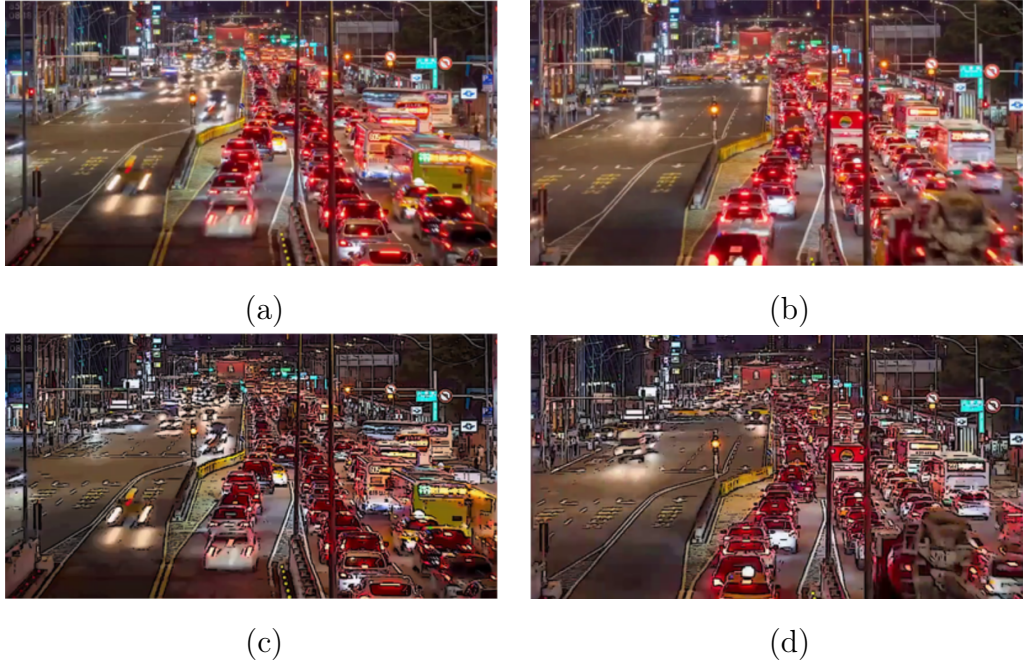
Figure 5.3: Dois frames originais retirados do vídeo "Trânsito"[19] (a,b) e respectivas imagens de abstração (c,d), obtidas com os seguintes parâmetros: s=2 ; \sigma_{color}=3 ; \sigma_{space}=3 ; \phi_{eq}=2 ; \sigma=1 ; \phi_e=5 ; \tau=0.992
