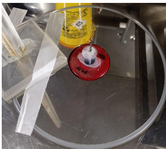
Figura 5.9: Base de plástico com seringa posicionado na extremidade superior do calibrador Comecer em d=L .
