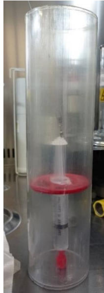
Figura 5.5: Posicionamento inicial da seringa na inserção de acrílico dos CD da Capintec com o auxílio da base de plástico.
