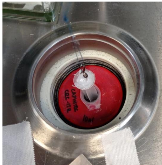
Figura 5.8: Base de plástico com seringa posicionado na extremidade superior do calibrador Capintec em d= L .
