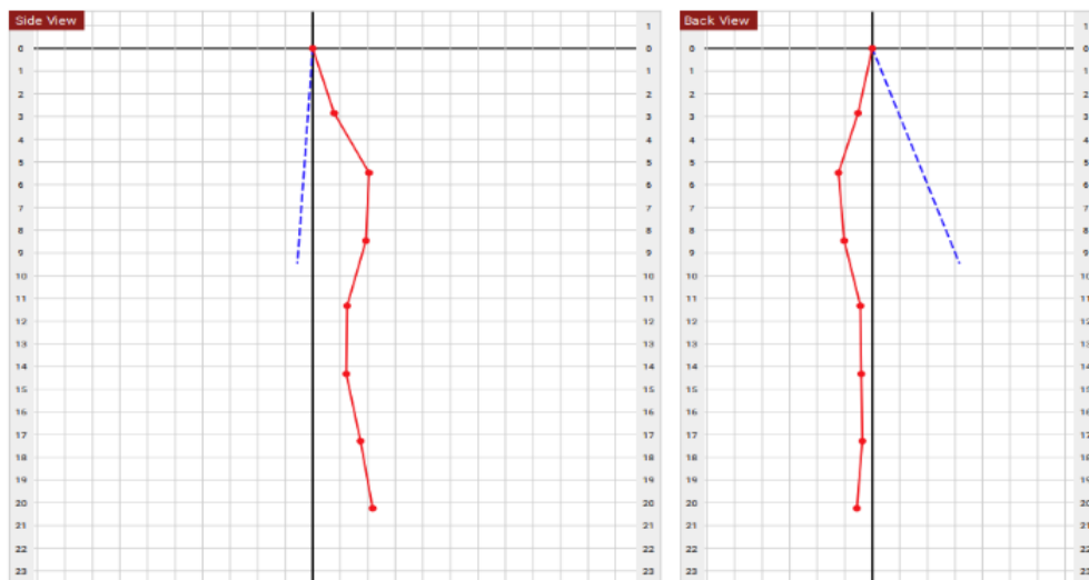
Figura 29. Menos de 3m de intervalo de medição, com media de azimuth de 11,62°, media angular de 12,75°, uma diferença de desvio de 11,72m.
