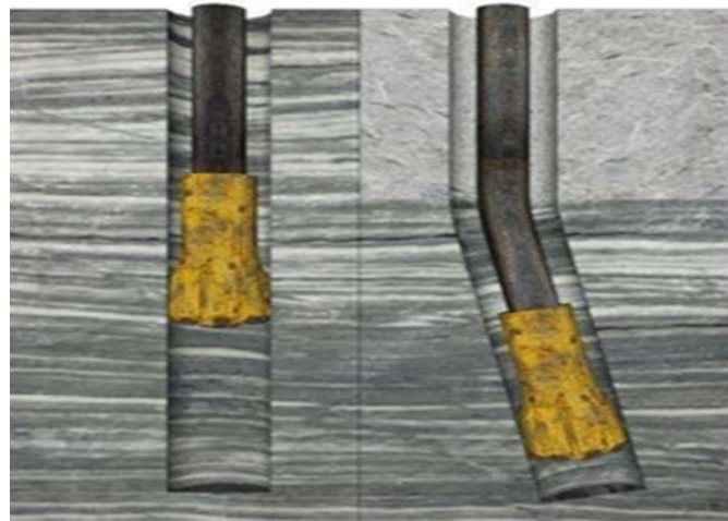
Figura 9. Encurvamento da haste quando a broca de perfuração passa de um meio mais brando a um de maior competência. Ilustração do autor adaptado de Hardrockdrills (2018).
