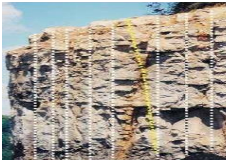
Figura 10. Desvio de furo causado pela transição da rocha (Frank G., 2021).
