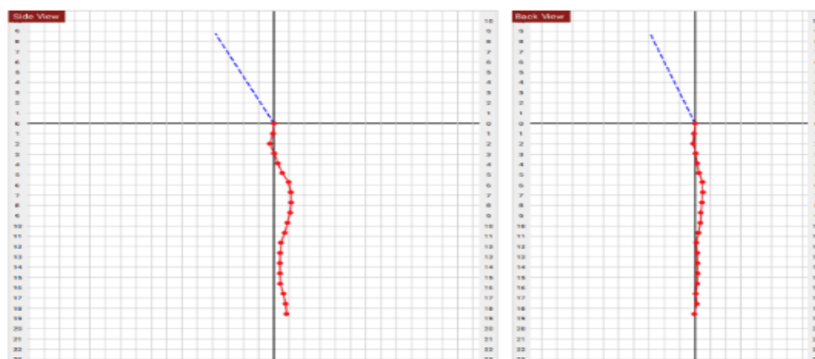
Figura 23. Perfil obtido a 1m de passo com o método Uphole, com media de azimuth de 2,8°, media angular de 10,2°, uma diferença de desvio de 27,9m.
