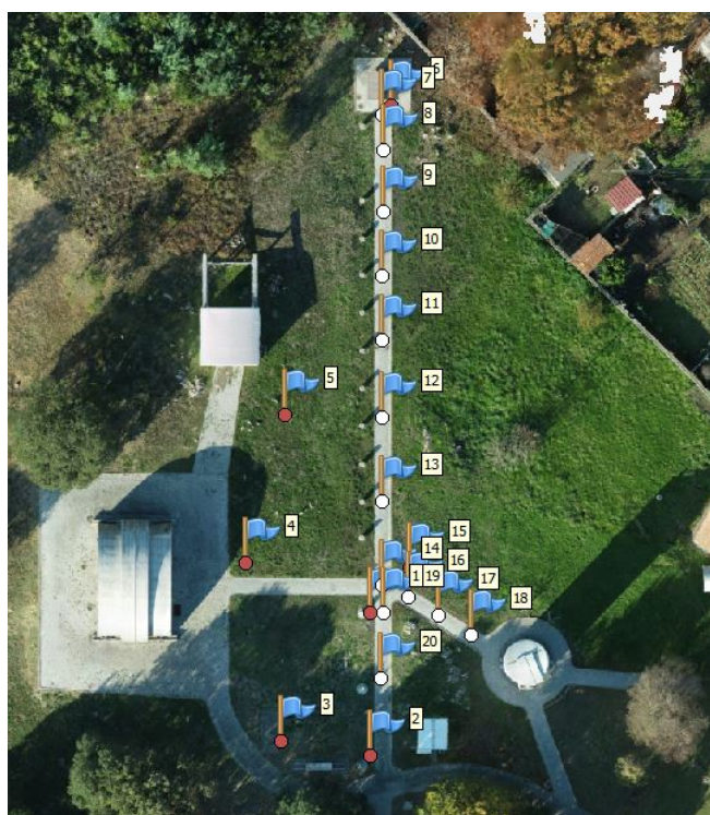
Figura 7: Pontos de verificação (branco) e pontos de controlo (vermelho) usados no observatório.
