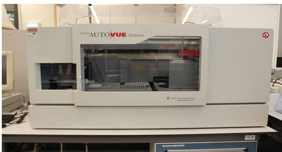
Figura 75- Equipamento Ortho AutoVue System disponível no setor de imunohematoterapia para a determinação de grupos sanguíneos, Coombs direta e indireta e estudo de compatibilidade transfusional.
