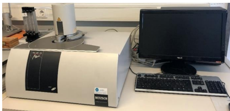
Figura 41 - DSC 200 F3 Maia®, NETZSCH
