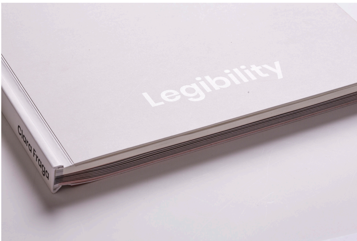
Figura 56 – impressão a verniz transparente - note-se, nas imagens a cima, o detalhe de impressão a verniz transparente sobre folha branca.
