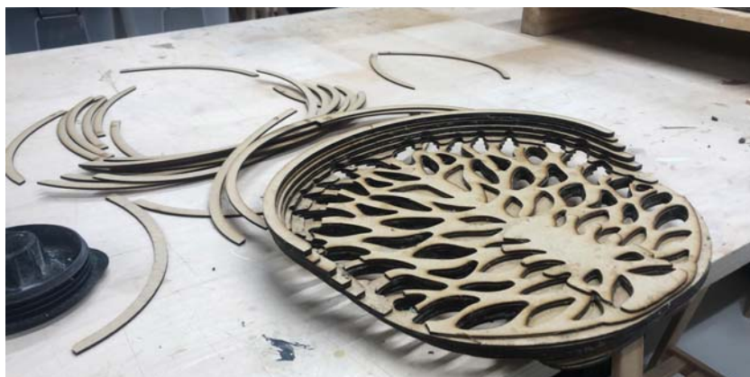
Figura 395: Montagem e colagem das várias camadas após corte (imagem do autor).
