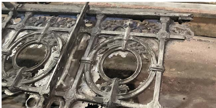
Figura 243: Um pormenor em que se vê locais com uma superfície fina de metal que não é suposto existir na peça final (imagem do autor).
