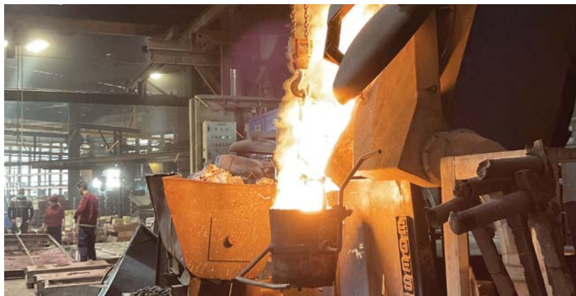
Figura 236: Vazamento do ferro fundido para o balde (imagem do autor).
