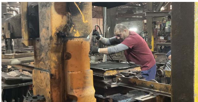
Figura 232: Operário com calcadeira elétrica a preensar a areia contra o modelo (imagem do autor).
