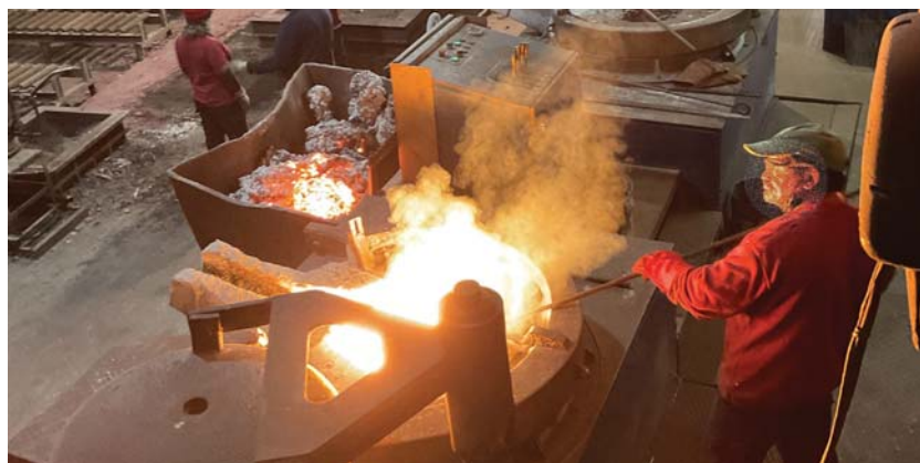
Figura 235: Forno onde os vários componentes para fazer a liga são juntos em matéria líquida. É possível ver o contentor em frente do forno para onde o operário atira a escória (imagem do autor).
