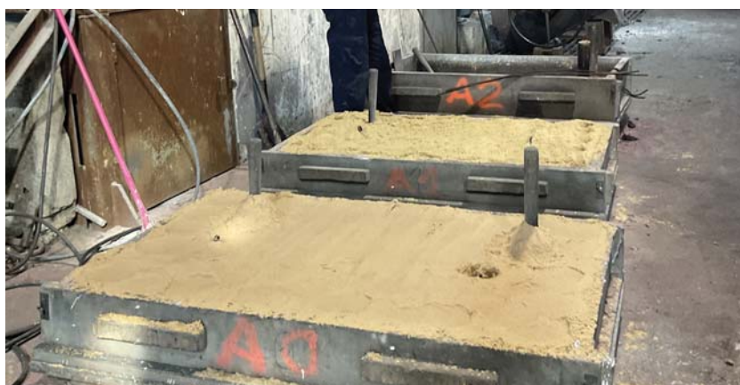
Figura 230: Caixa de areia com a areia e onde é possível ver os tubos que vão originar os canais para os gases saírem assim como os gilos (canais de entrada do metal) (imagem do autor).
