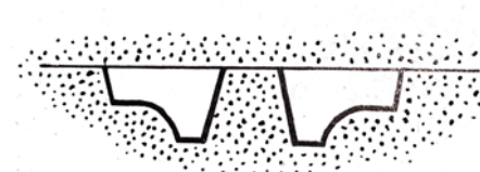
Figura 10: Há casos em que os machos nascem já do próprio modelo (Imagem de Cardoso1976a, pág.190).
