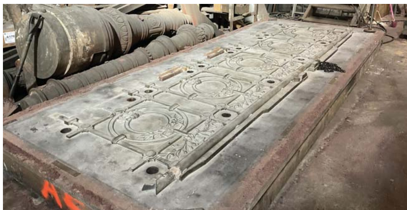
Figura 228: Modelo que depois irá originar o molde em areia. Este modelo irá ser prensado na areia (imagem do autor).
