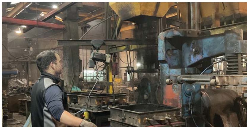
Figura 231: Operador de máquina a colocar areia já queimada que não entrará em contacto com o modelo para preencher a restante caixa (imagem do autor).
