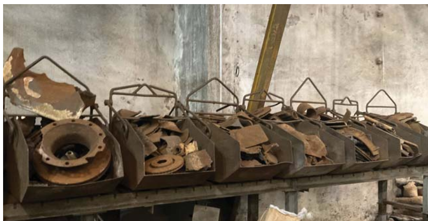
Figura 233: Local onde têm a sucata que é utilizada para fazer a matéria de ferro fundido (imagem do autor).
