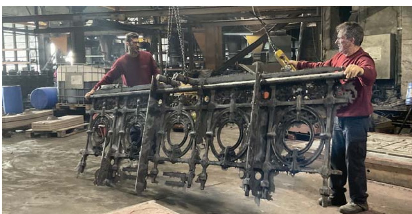
Figura 242: Peça retirada do molde, onde é possível ver que tem muitas aparas e ainda precisa de trabalho de acabamento (imagem do autor).
