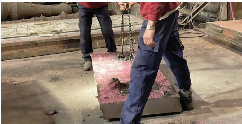
Figura 240: Após arrefecimento é tirada, neste caso, o molde de areia superior. A coloração avermelhada acontece pela areia ter ficado queimada (imagem do autor).
