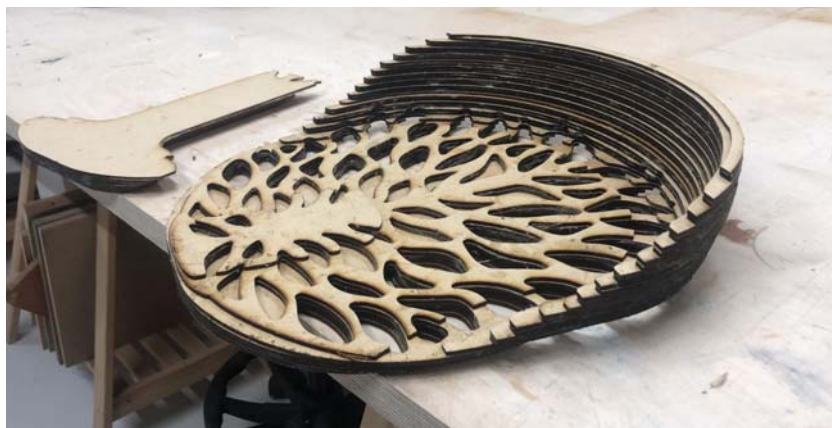
Figura 396: Colagem das várias camadas do encosto da maquete (imagem do autor).
