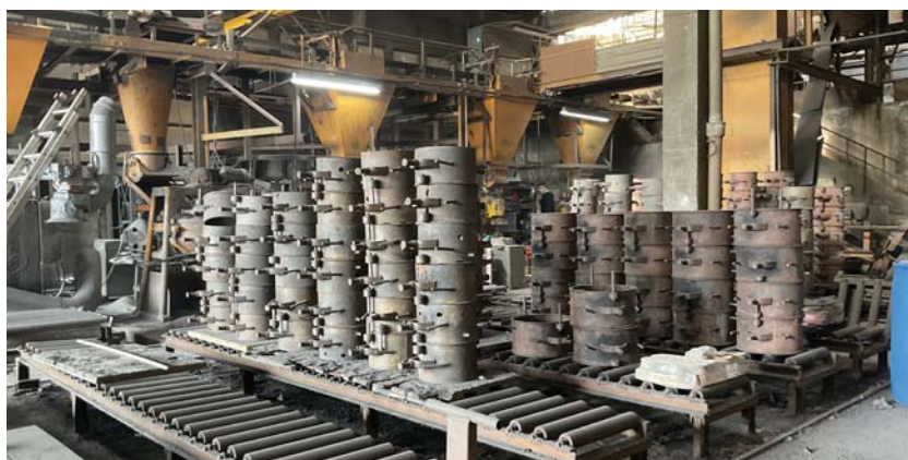
Figura 226: Local onde estão vários moldes circulares empilhados à espera de serem cheios (imagem do autor).
