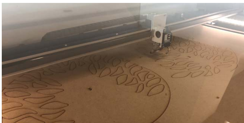
Figura 394: Visualização de um segundo corte em máquina a laser de placas de MDF para posterior colagem e elaboração de maquete à escala real (imagem do autor).
