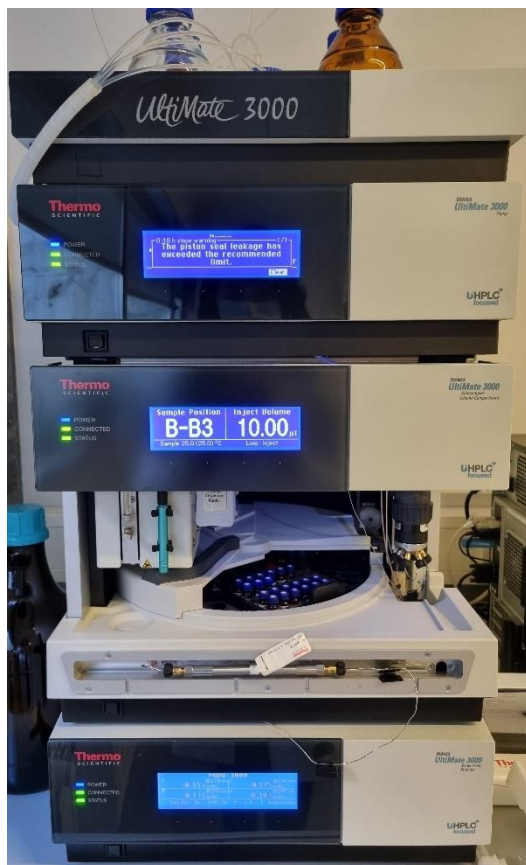
Figura 23 – HPLC - Dionex UltiMate 3000.
