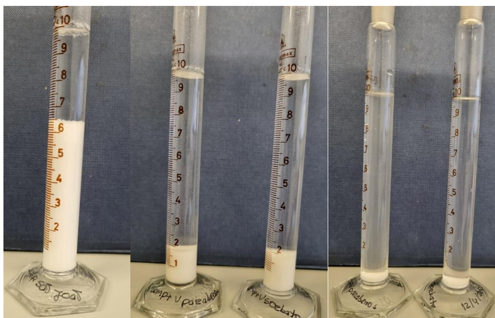
Figura 31 - Ensaio de sedimentação passados 31 dias.
