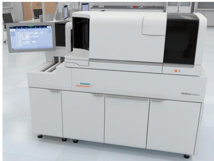
Figura 7. Autoanalisador de imunoensaios por quimioluminescência Atellica® IM 1600 Analyzer da Siemens Healthineers (12).
