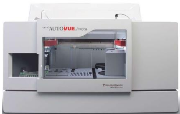
Figura 23. Analisador automático de testes imunohematológicos ORTHO AutoVue® Innova System através de cassetes ORTHO BioVue® da Ortho Clinical Diagnostics (35).
