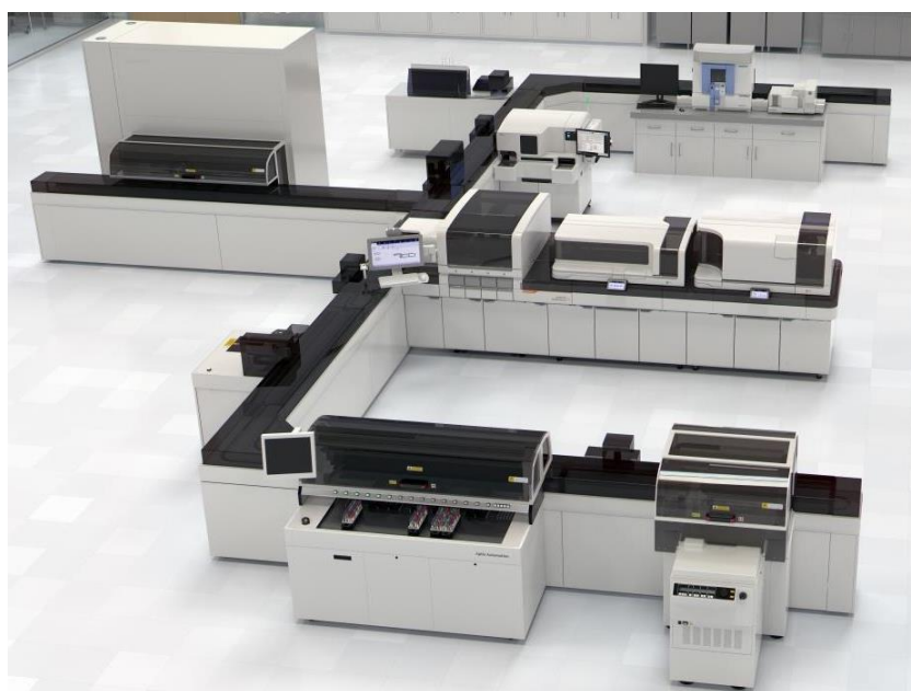
Figura 2. Linha de trabalho com diferentes módulos pré-analíticos e pós-analíticos Aptio® Automation da Siemens Healthineers (10).
