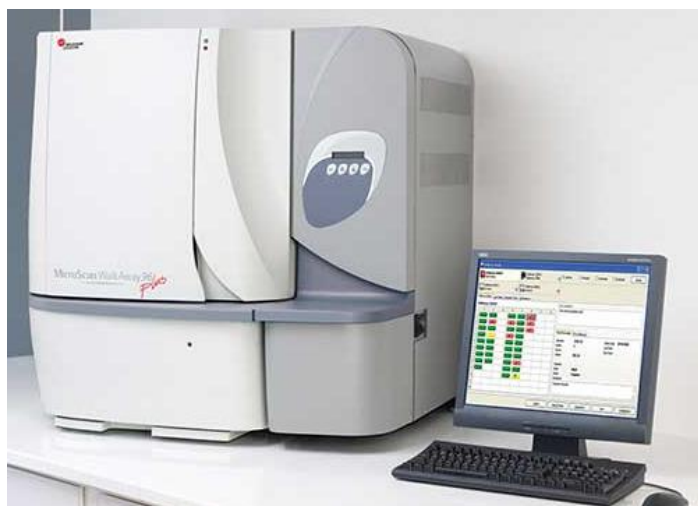
Figura 30. Sistema MicroScan WalkAway 96 plus da Beckman Coulter para a realização de antibiogramas (43).
