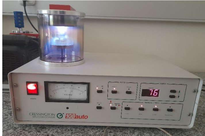
Figura 32 - Equipamento para recobrimento das amostras com ouro
