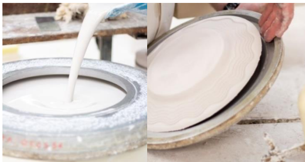
Figura 9 - Produção de moldes em gesso
