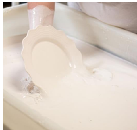
Figura 13 - Processo de vidragem por imersão
