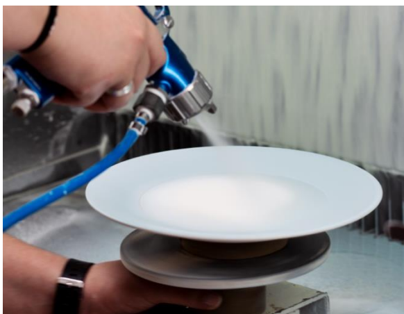
Figura 12 - Processo de vidragem por pulverização
