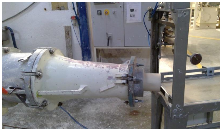
Figura 7 - Extrusora de pasta de porcelana
