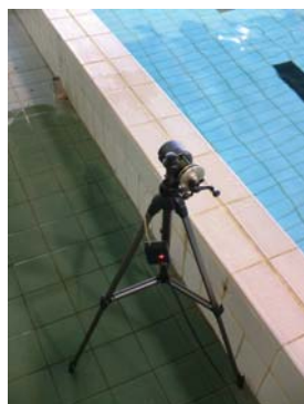
Figura 5: Velocímetro desenvolvido por Lima et al. (2003).
