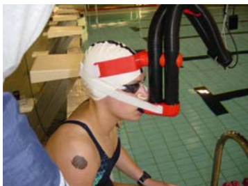
Fig. 4 e 5 - Válvula de Toussaint et al. (1987), específica para a NPD, adaptada para o dispositivo do Breath by Breath (Keskinen et al., 2003).
