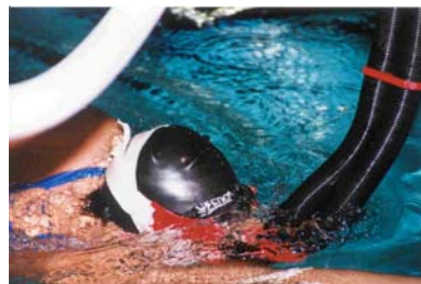
Fig. 4 e 5 - Válvula de Toussaint et al. (1987), específica para a NPD, adaptada para o dispositivo do Breath by Breath (Keskinen et al., 2003).
