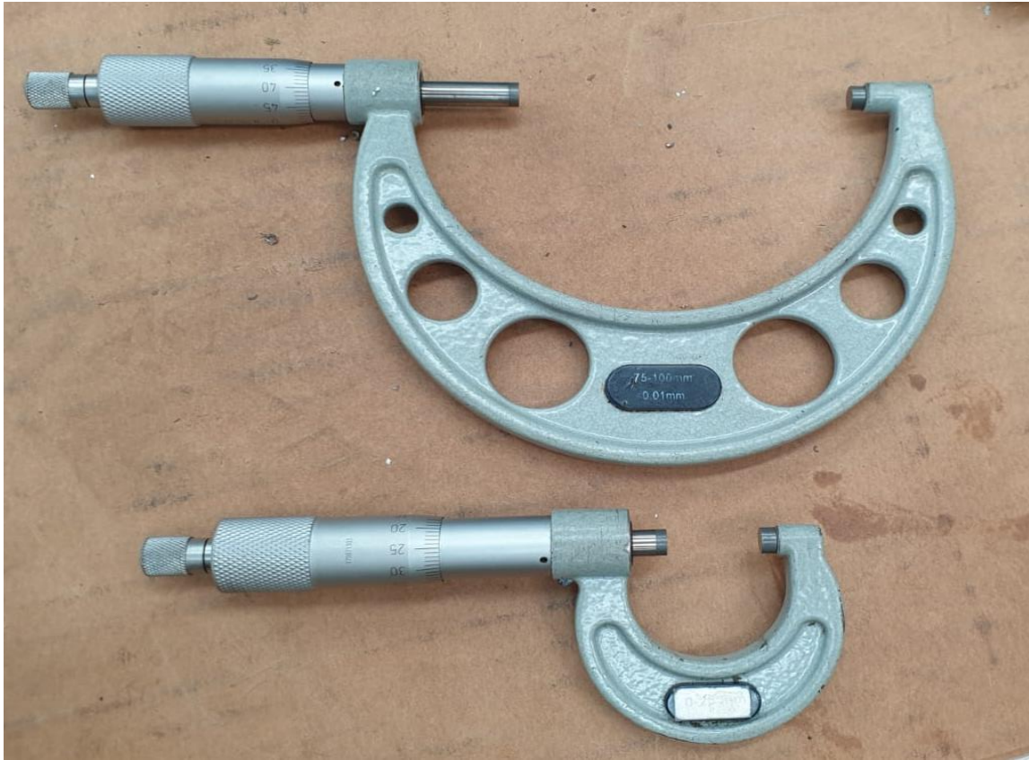
Figura 22 - Micrometros de exteriores com gama de medição de 75 a 100mm (cima) e 0 a 25mm (baixo)
