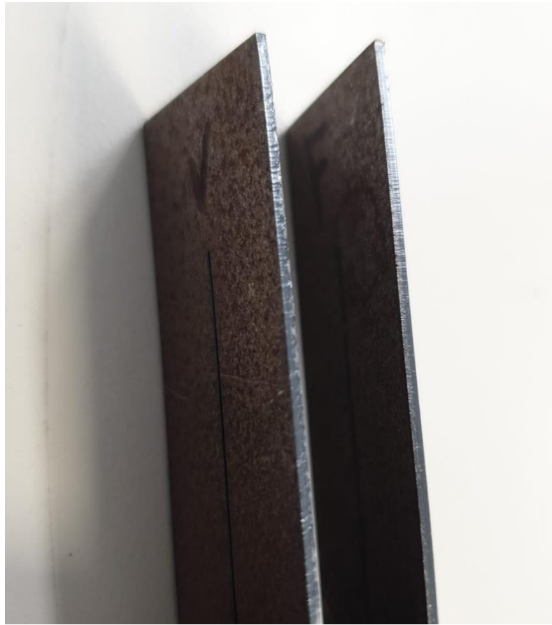
Figura 19 - Provete cortado com os parâmetros da empresa (esquerda) e com os parâmetros ótimos obtidos neste ensaio (direita).
