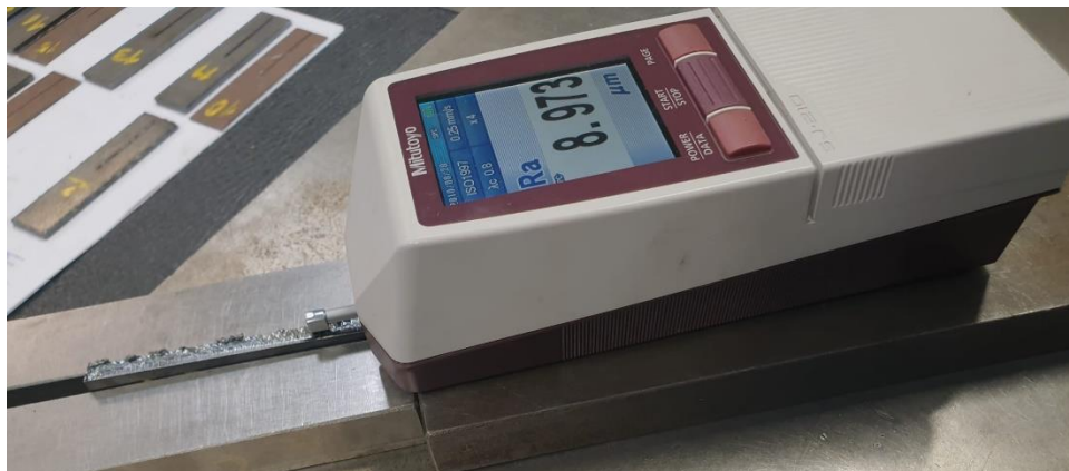
Figura 13 - Medição da rugosidade da face de corte de um provete
