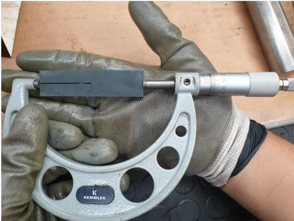
Figura 10 - Medição do comprimento do provete
