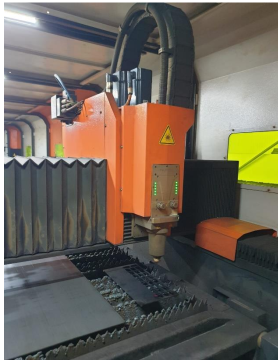
Figura 8 - Cabeça, mesa e sistema de movimentação do laser em estudo
