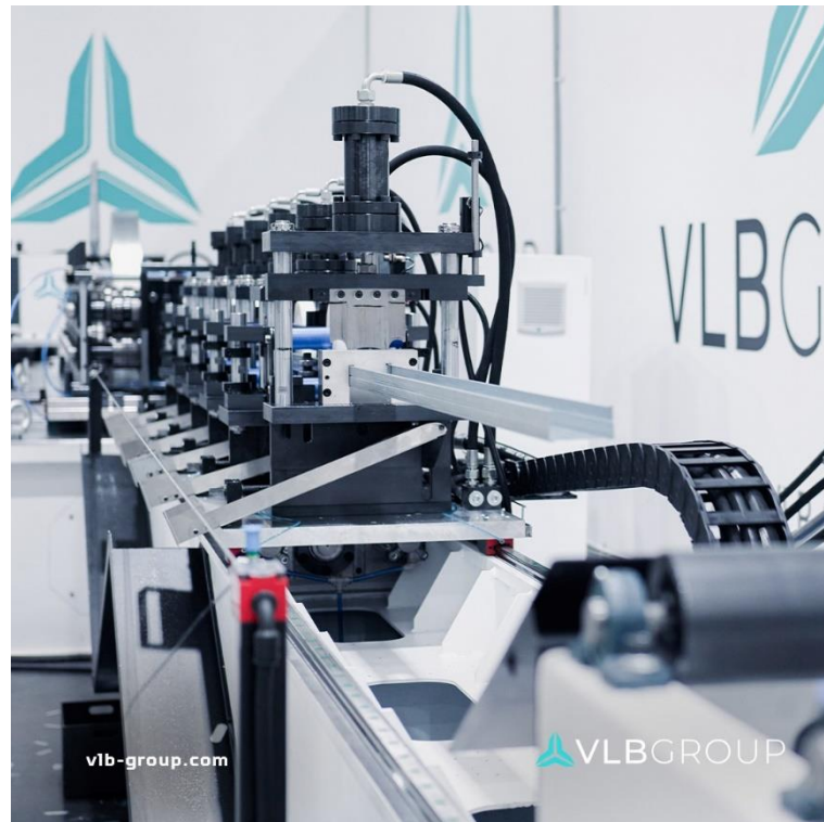
Figura 1 - Linha de conformação de chapa (VLB Group, 2022)
