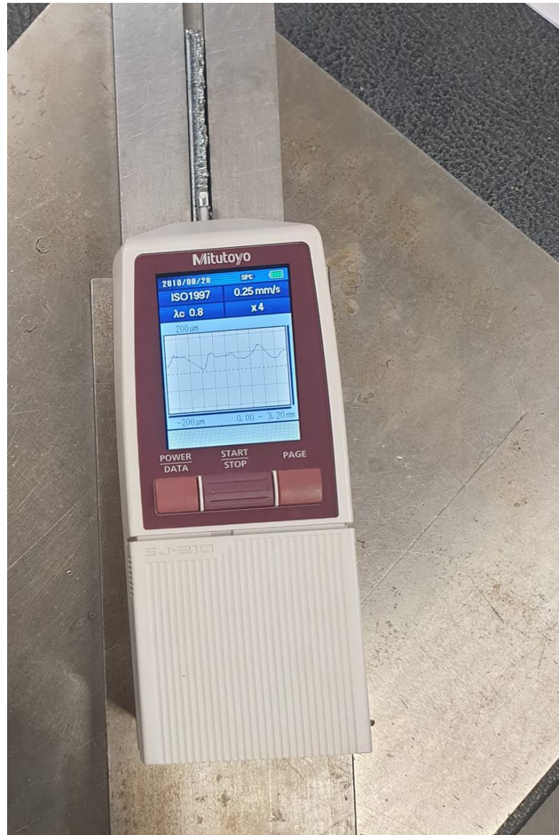
Figura 23 - Rugosímetro disponibilizado pela FEUP para esta dissertação
