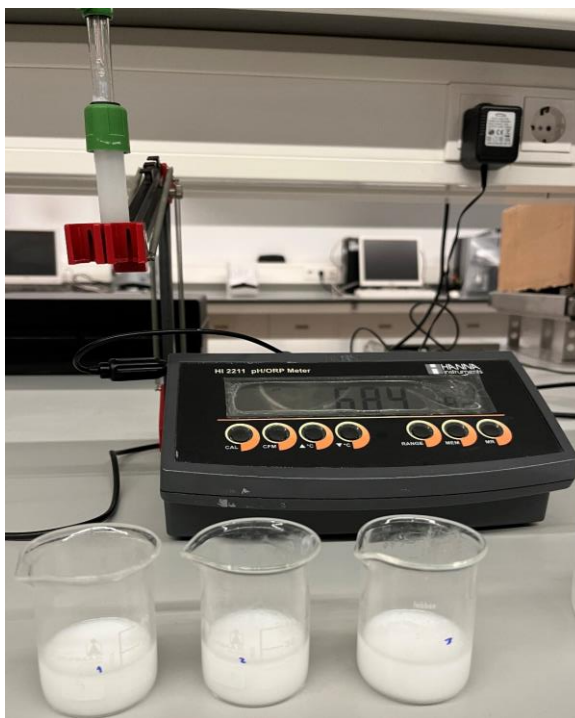
Figura 8- Potenciômetro Hanna Instruments 2211 (Roménia).
