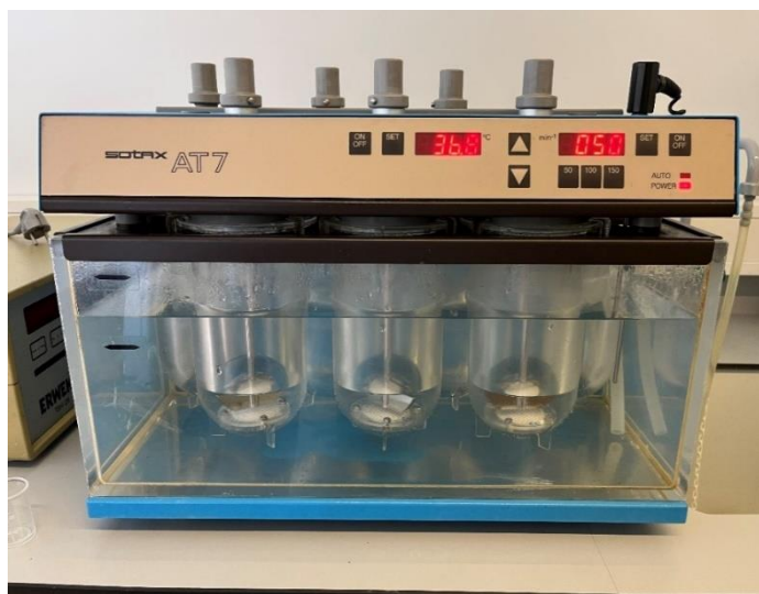
Figura 17- Aparelho de dissolução Sotax AG AT7 com pás agitadoras e recipientes com as amostras.
