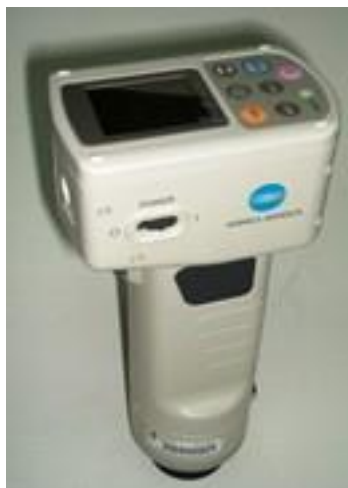
Figura 7- Colorímetro Konica Minolta Chroma Meter 400 (Japão).
