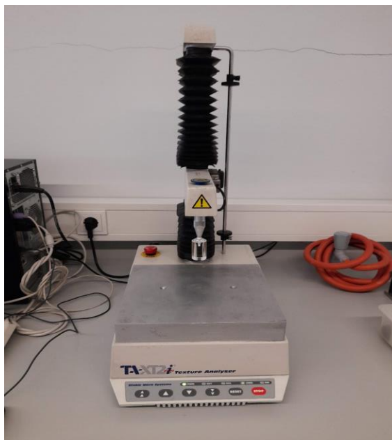
Figura 13- Texturómetro Stable Micro Systems TA-XT2i (Reino Unido) com a sonda utilizada no ensaio da análise da textura.
