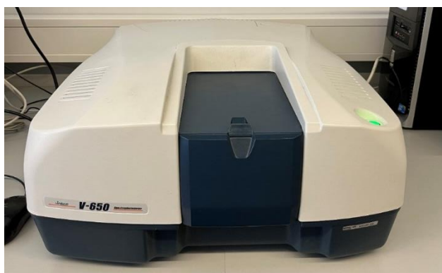
Figura 16- Espectrofotômetro UV-Vis Jasco V-650 (Japão).
