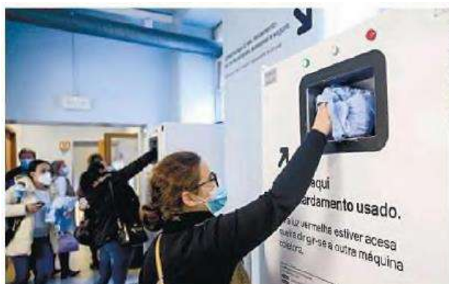
Figura 46 Máquina de deposição de fardas lê as peças e rastreia ciclo hospitalar Foto: Artur Machado / Global Imagens (de https://www.jn.pt/nacional/chip-nas-roupas-do-s-joao-mantem-fardas-sempre-disponiveis-14285548.html )
