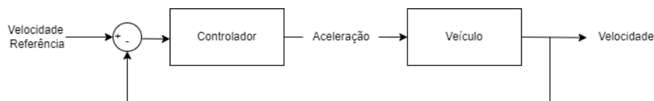
Figura 2.1: Arquitetura de controlo em CC.
