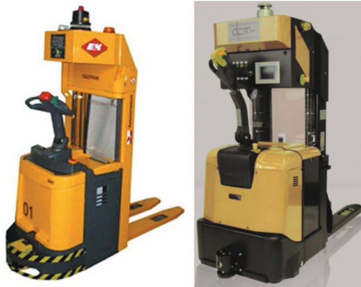
Figura 2.2: Exemplo de dois AGV Forklift com produção em série (Esquerda EK, Direita DPM)[1]
