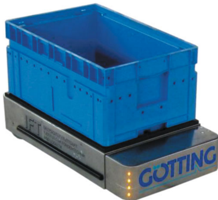
Figura 2.1: Exemplo de um Mini-AGV- KATE ( desenvolvido pela Gotting) [1]
