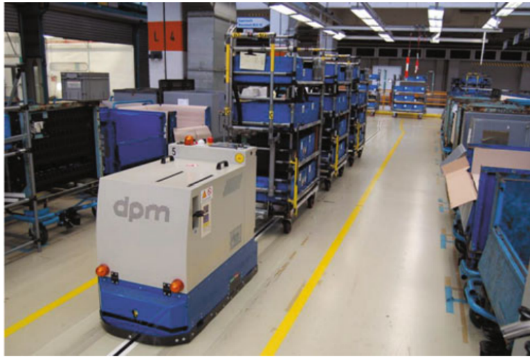
Figura 2.3: Exemplo de um Tugger construído pela DPM[1]
