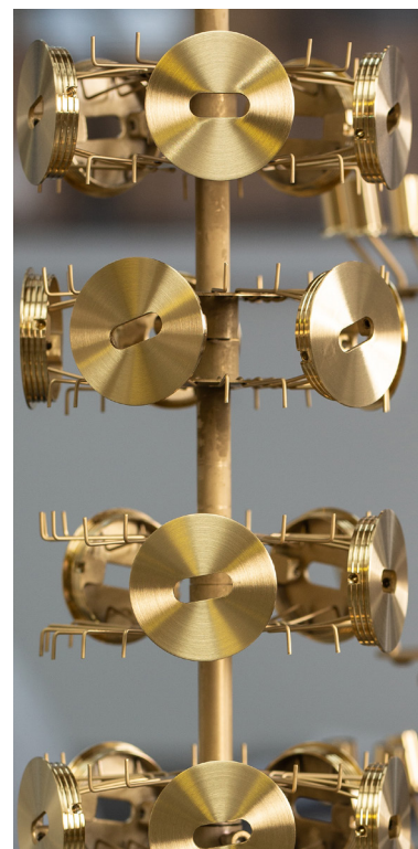
Figura 69 - Peças de aço inox revestidas a titânio, recorrendo à tecnologia de PVD.
