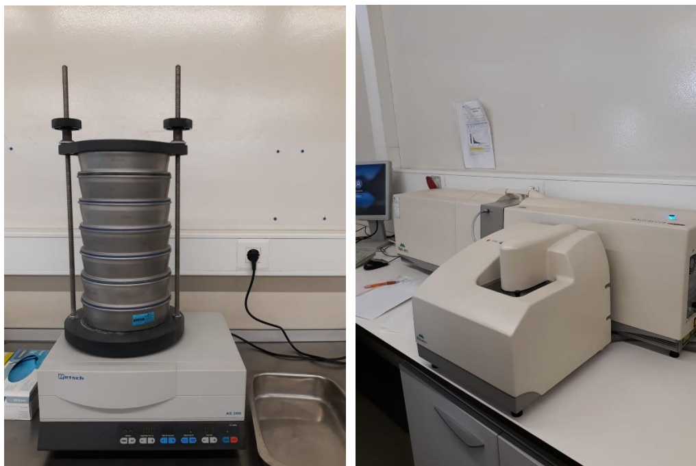
Figura 11 – a) Representação de uma série de crivos b) Granulómetro de raio laser - Mastersizer.
