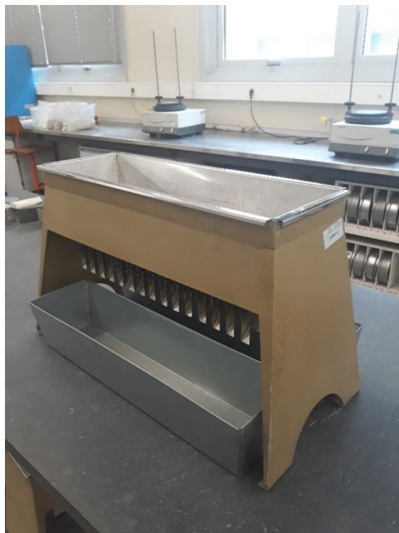
Figura 10 – Esquartelador utilizado na divisão da amostra.
