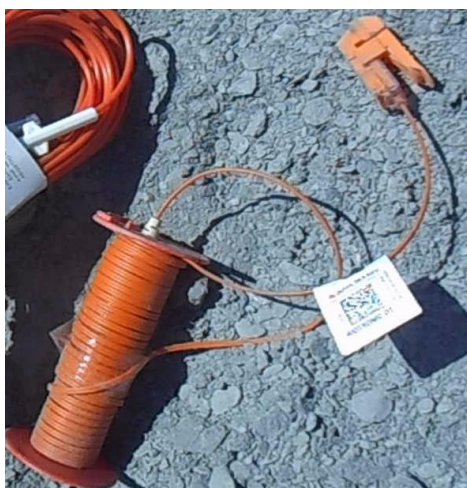
Figura 11 - Exemplo de um detonador eletrônico (Leite, Sistemas de iniciação, 2018)
