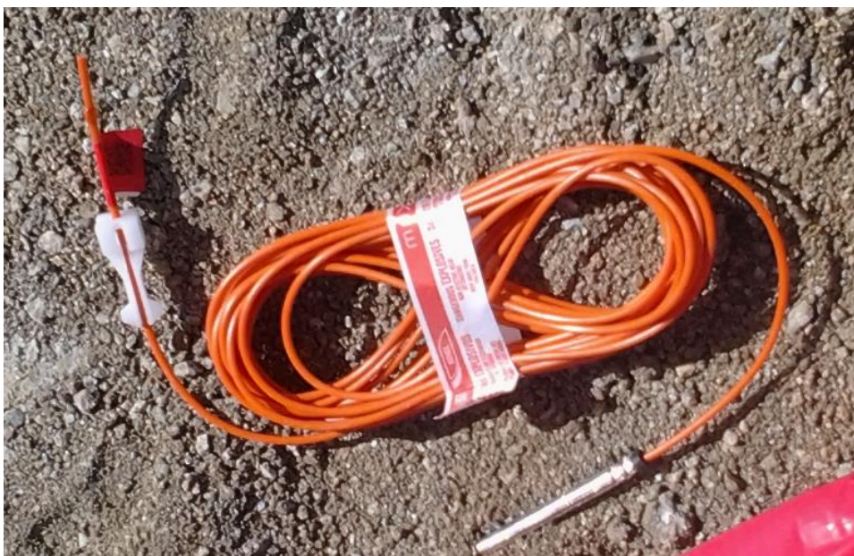
Figura 9 - Exemplo de um detonador não-elétrico (Leite, Sistemas de iniciação, 2018)
