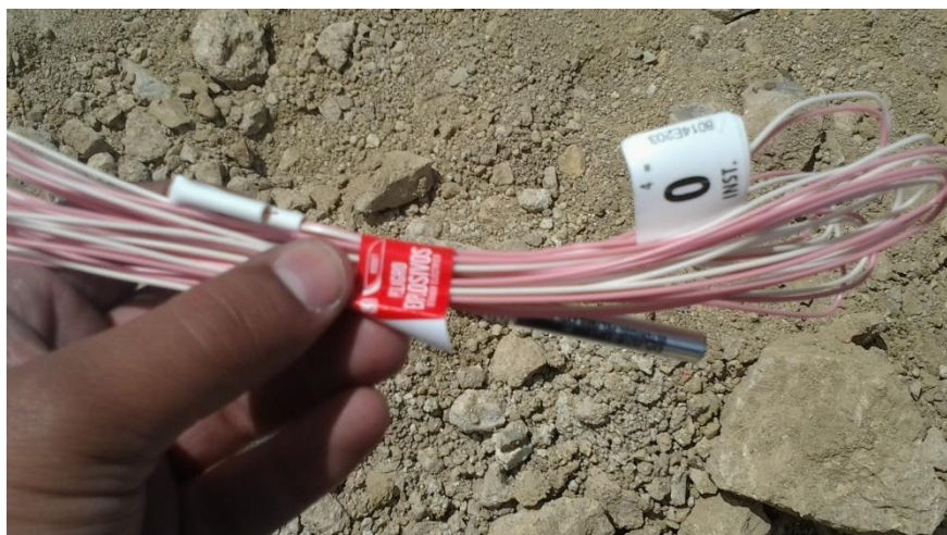
Figura 7 - Exemplo de um detonador elétrico (Leite, Sistemas de iniciação, 2018)
