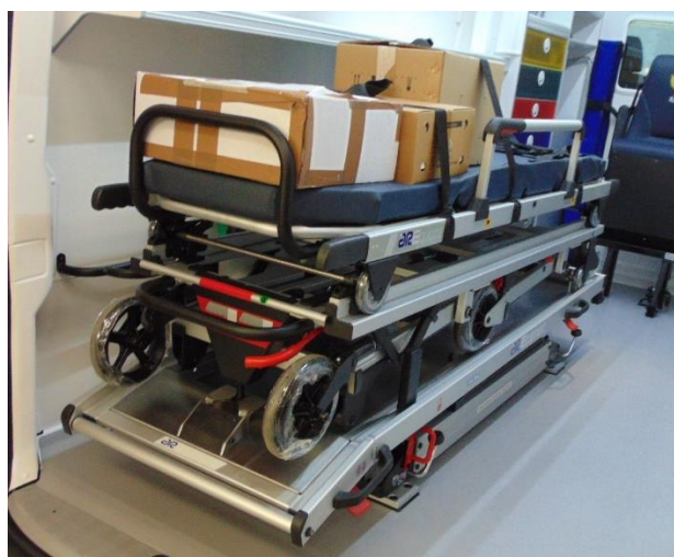
Figura 28 Representação montada do charriot, carrinho e maca (AR)
