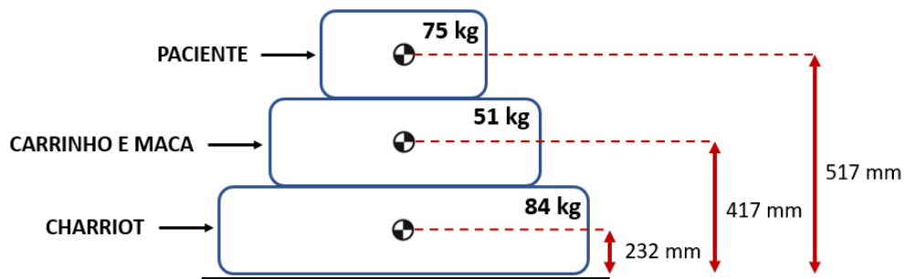
Figura 29 Diagrama do conjunto e seus respectivos centros de gravidade
