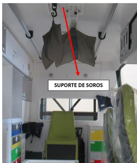
Figura 33 Simulação suporte de soros (AR)
