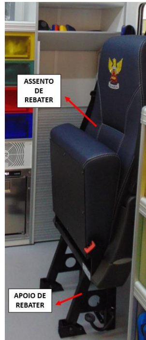
Figura 31 Conjunto do banco encosto de rebater (AR)
