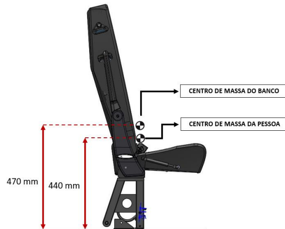
Figura 32 Diagrama centro de massa do conjunto banco assento de rebater e pessoa
