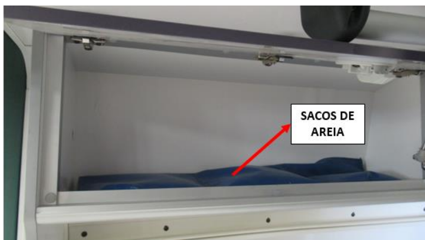
Figura 16 Preparação em armário de teto (AR)
