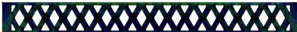
Figura 5.1 - Distribuição da tensão de von Mises para o modelo aproximado com a condição de contorno biapojada.
