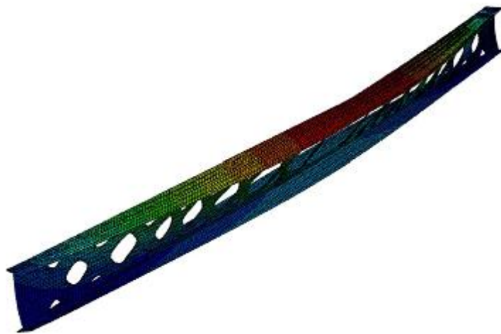
Figura 4.26 - W310x28,3 Otimizada - condição de contorno biengastada.
