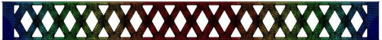
Figura 5.4 - Deslocamento máximo para o modelo aproximado com a condição de contorno biengastada.
