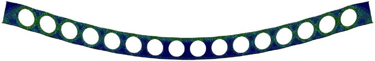
Figura 4.18 - Distribuição da tensão de von Mises para a viga celular W310x28,3 com condição de contorno biengastada.
