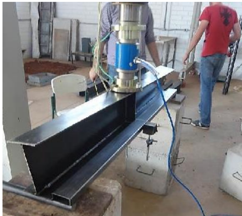
Figura 2.13 - Encurvadura lateral por torção em viga perfil I [46]
