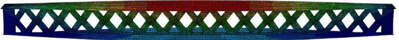
Figura 5.5 - Modo de encurvadura da viga de modelo aproximado com condição de contorno biapoçada.
