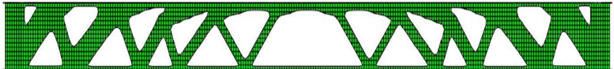
Figura 4.9 - Topologias para as vigas biapoiadas obtidas após o processo de otimização através do método SIMP para o fator de penalidade p = 4 .
