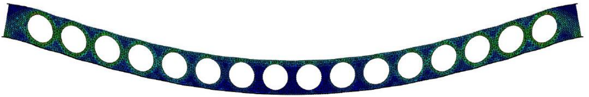
Figura 4.19 - Distribuição da tensão de von Mises para a viga celular W310x52 com condição de contorno biengastada.
