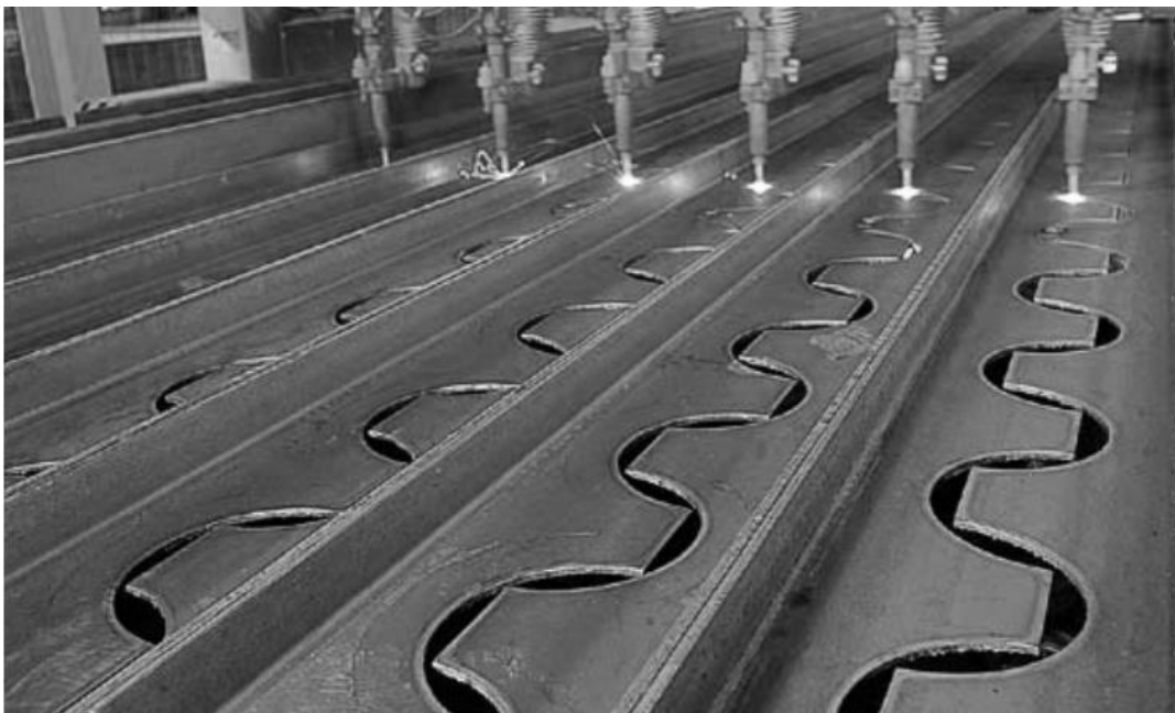
Figura 2.9 - Procedimento de corte automatizado na produção das vigas celulares [40]
