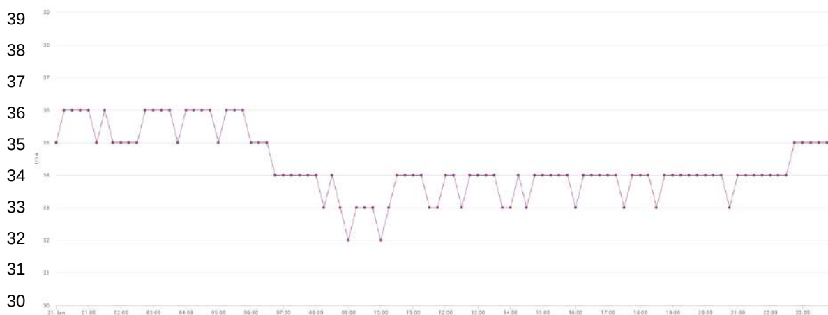
Figura 3. 16 – Variação da pressão comunicada pelo data logger da Rua de Dr. Ricardo Jorge, no Porto.
