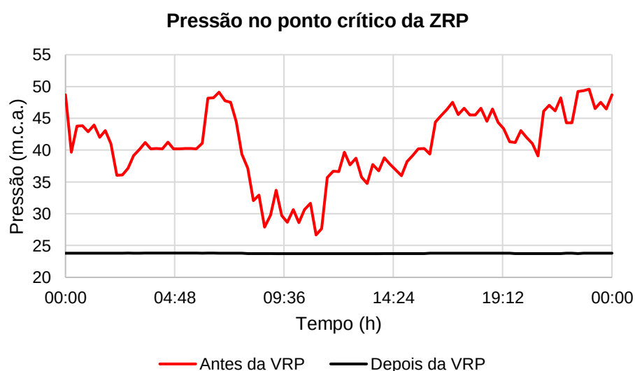
Figura 6. 23 – Variação da pressão no ponto crítico da ZRP após a instalação da VRP.
