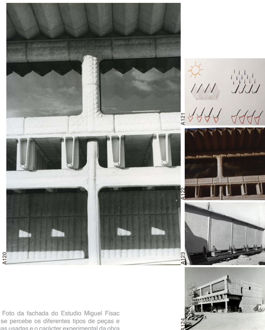
A121 Esquízo de Miguel Fisac onde explica as três vertentes lógicas que levaram ao desenho destas peças, entrada de luz indireta, a proteção da luz direta e caleiras para escoamento da chuva
